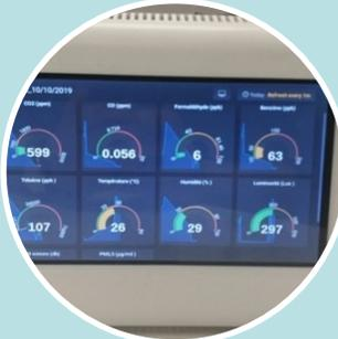
Pilotage intelligent du système de ventilation grâce à un smart capteur
