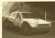
quatre roues motrices, engagé dans les Rallyes de Tunisie et de l'Atlas, qui a été construit de façon artisanale à Montauban, est motorisé par un moteur V6-PRV de 2,85 litres de cylindrée, turbo compressé, développant 260 ch et donnant 42 mgk à 2000 tours/mn.
