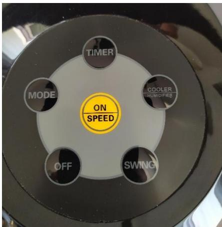
Au-delà de la fonction ventilateur classique. « Cooler » permet de mettre en fonction la fonction utilisant le réservoir d'eau
