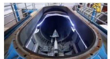
Figure 13: soufflerie JF-12 de l'IMECH à Pékin
