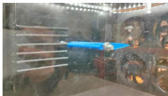
Figure 26 : tubes en cuivre de l'injecteur
