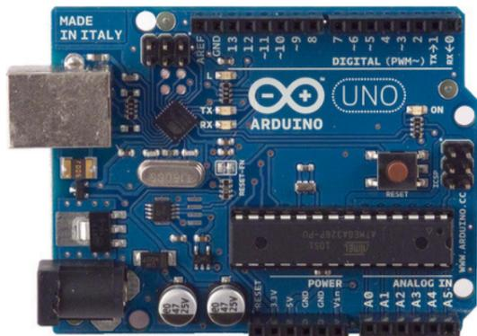
Version de base du système basé sur un Atmega 328 cette carte délivre un maximum de 14 points d'entrée / sortie digitaux et de 6 entrées analogiques. Existe avec un processeur en version Dil sur support ou SMD soudée.
