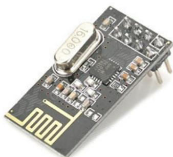
Module radio travaillant dans la bande des 2.4 Ghz et basé sur le chipset nRF24L01+ de Nordic semiconductor. Ce module a une portée d'environ 100m et un débit possible maximal de 2Mbs.
