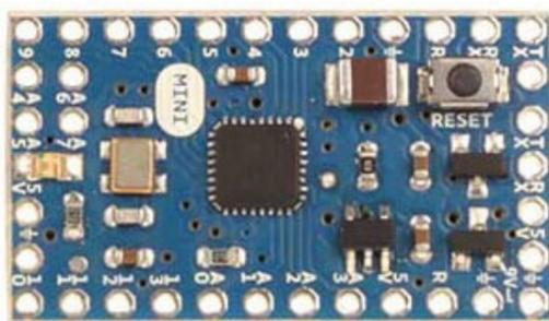
Carte Uno disposant d'un Atmega 328 au format TQFP ce qui lui permet d'obtenir 2 ports d'entrée analogique supplémentaire.
