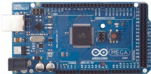
Peu de différences de principe avec les cartes précédentes, basée sur un processeur Atmel 1280, cette carte est une des plus complètes de la gamme avec un nombre de ports E/S de 54 points digitaux et 16 analogiques. Les connecteurs d'extensions sont prévus pour accueillir les cartes filles des modèles Uno ou Duemilanove.
