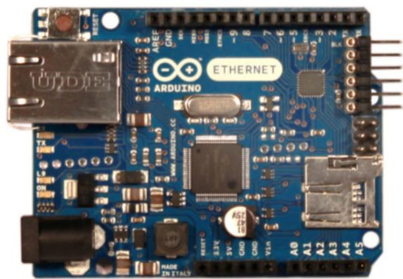
Carte Uno 328 disposant d'une interface Ethernet intégrée, celle-ci pouvant être de type POE.
