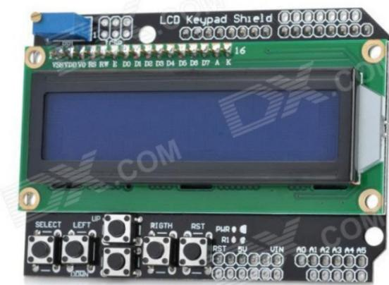
Modèle courant constitué d'un afficheur LCD 2 lignes de 16 caractères, et d'une série de touches codées en analogique.
