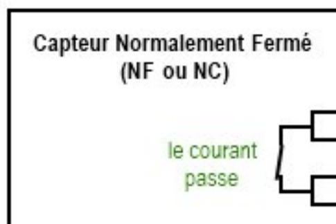
FIGURE V.2.2. – Schéma d'un capteur normalement fermé
