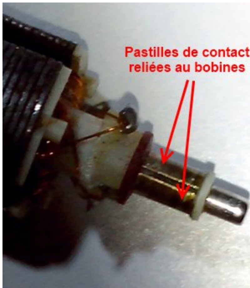
FIGURE VI.1.15. – Rotor d'un moteur à courant continu, encore
