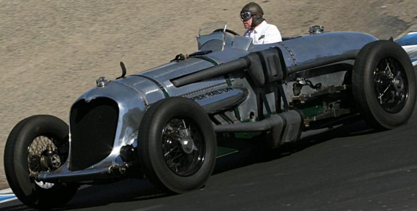
Moteur aéronautique de 12 cylindres et 2,4 litres. Puissance estimée à 600 cv.
