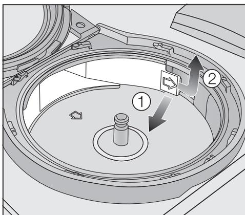
■ Déverrouillez le canal d'écoulement au niveau de la languette (flèche) ① et le sortir ②.
