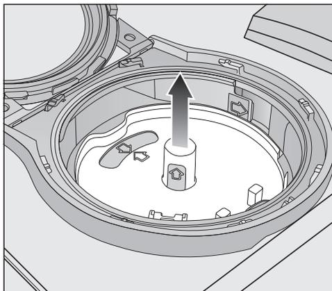
■ Retirez le logement du PowerDisk par le haut au niveau des surfaces jaunes des poignées. Ce faisant, ne tirez pas sur la languette latérale.
