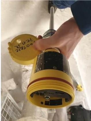
De 9h30 à 11h30 : Nous avons été chercher une sonde au magasin général, afin d'effectuer des tests afin de savoir ce qui était défectueux. Nous avons su assembler la sonde et le côté numérique d'une autre sonde afin d'en récupérer une au lieu de prendre la nouvelle du magasin. Ce qui nous a permis de faire une économie d'une sonde.
