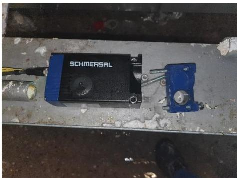
Ensuite, nous avons été envoyés en renfort sur des problèmes de capteurs qui servent à fermer une porte lorsque la machine est en fonctionnement. (De la sécurité). Nous avons du ponté les capteurs car ils étaient défectueux. Les ouvriers de la division lavent les machines à grande eau, à l'étage du dessus, et il y avait beaucoup d'humidité. Les capteurs ne sont malheureusement pas waterproof.
