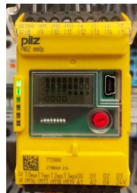
Dans la présente installation, quatre boutons poussoirs d'arrêt d'urgence sont reliés au PNOZ ainsi que quatre boutons poussoirs classiques destinés aux resets. Il y a également trois capteurs de fermeture de portes du même fabricant. Chaque poste comprend un bouton d'arrêt d'urgence, un bouton de reset et un capteur de porte sauf le touch panel qui ne comprend pas de capteur de portes. Chaque sortie de l'appareil est destinée à couper l'alimentation 24V de la cellule concernée.
