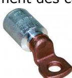
Les cosses bi-métal sont constituées d'une plage en cuivre et d'un fût en aluminium à sertir par poinçonnage profond ou à sertir par rétreint<sup>1</sup> hexagonal.
