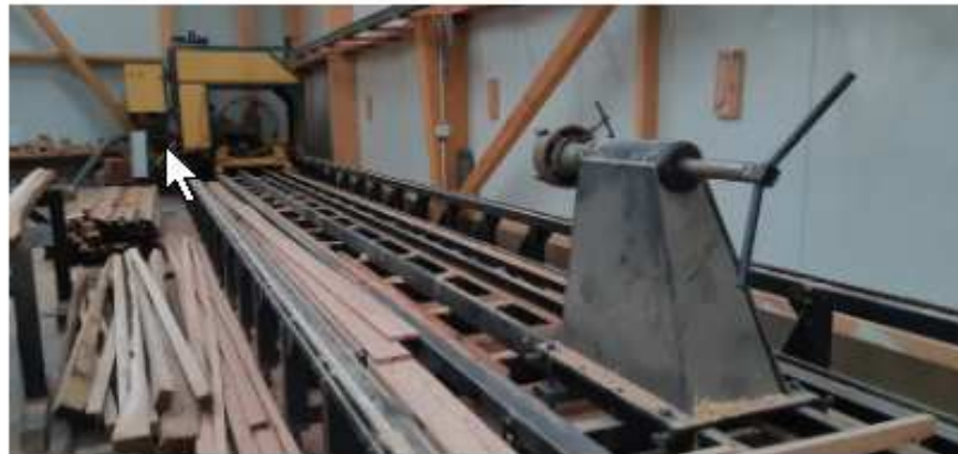
Le tour à bois, unique en Europe, qui permet de fabriquer des mats de 30 mètres © Radio France - François Rivaud
