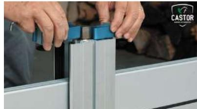
7. Descendre le vérin serreur jusqu'à ce qu'il soit en contact avec la planche.
