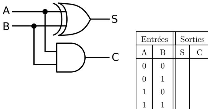
Ce circuit calcule le bit de somme des bits A et B en S et une éventuelle retenue en C (carry en anglais). Pour concevoir un circuit logique capable d'additionner des nombres binaires, il faut pouvoir tenir compte de la propagation d'une éventuelle retenue. Il s'agit d'additionner A et B et une retenue  $C_{in}$  (valant 0 ou 1). On obtiendra alors un résultat en sortie S ainsi qu'une retenue  $C_{out}$  (valant 0 ou 1).
