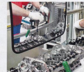
L'assemblage du système VT est intégré à la ligne existante : l'arbre excentrique et son moteur électrique, la rampe d'injection, la mise en tension des ressorts ...
