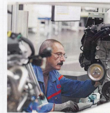
La boucle culasse VDI pour l'assemblage de la fonction haute pression de l'injection directe (pompe et tube HP), créée pour minimiser les impacts process.
