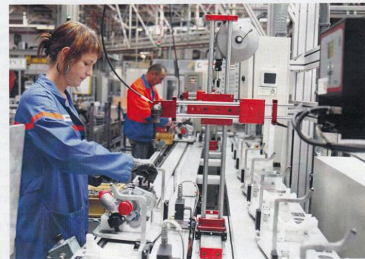
L'assemblage de la pompe à huile, modifié pour l'EP euro 5.
