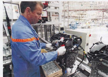
Le tbo « twin-scroll » est préparé (à gauche) puis assemblé (ci-dessus) dans le process existant.
