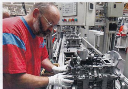
L'assemblage de la pompe à huile, modifié pour l'EP euro 5.
