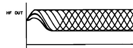
Oszilloskopstellung 0,5  $\mu$ s/div. Amplitude ca. 1,5 V.
