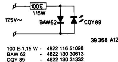
Die Speisespannung einschalten und das Abspielgerät in die BEREITSCHAFTSSTELLUNG oder in die Servicestellung 0 überführen. Die IR-Diode CQY 89 ersetzt bei dieser Messung die Funktion der Laserdiode. Dadurch dass diese Diode über die Objektiveneinheit gehalten wird, fällt das Infrarotlicht auf die 4 Lichtdioden.
