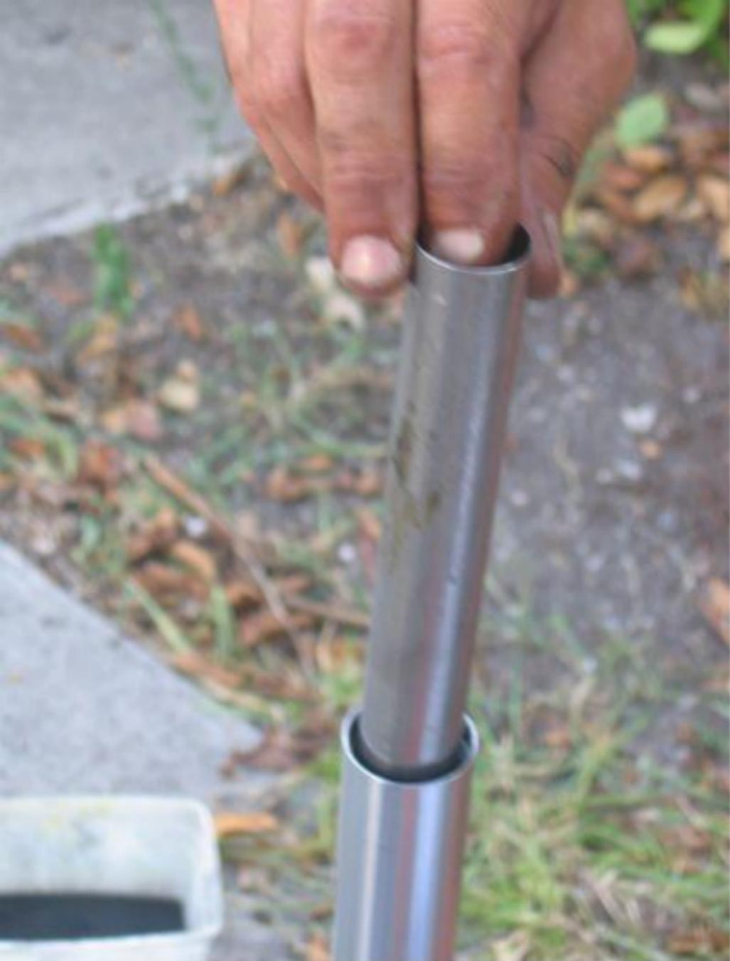
**Remettre en place les pièces du tube dans l'ordre suivant : ressort, rondelle, cale, bouchon. Visser le bouchon sans le serrer (le serrage final ne pourra se faire que tube bloqué par les tés). Réengager les soufflets**
