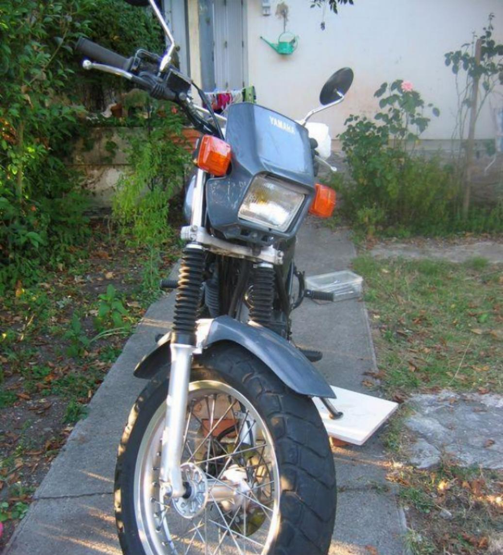
**Procéder à une vérification complète des serrages (tés, tubes, étrier, passe-câbles, axe de roue). Vérifier le bon fonctionnement du compteur et des freins. Remettre en place le garde-boue et faire une pause bien méritée ...**
