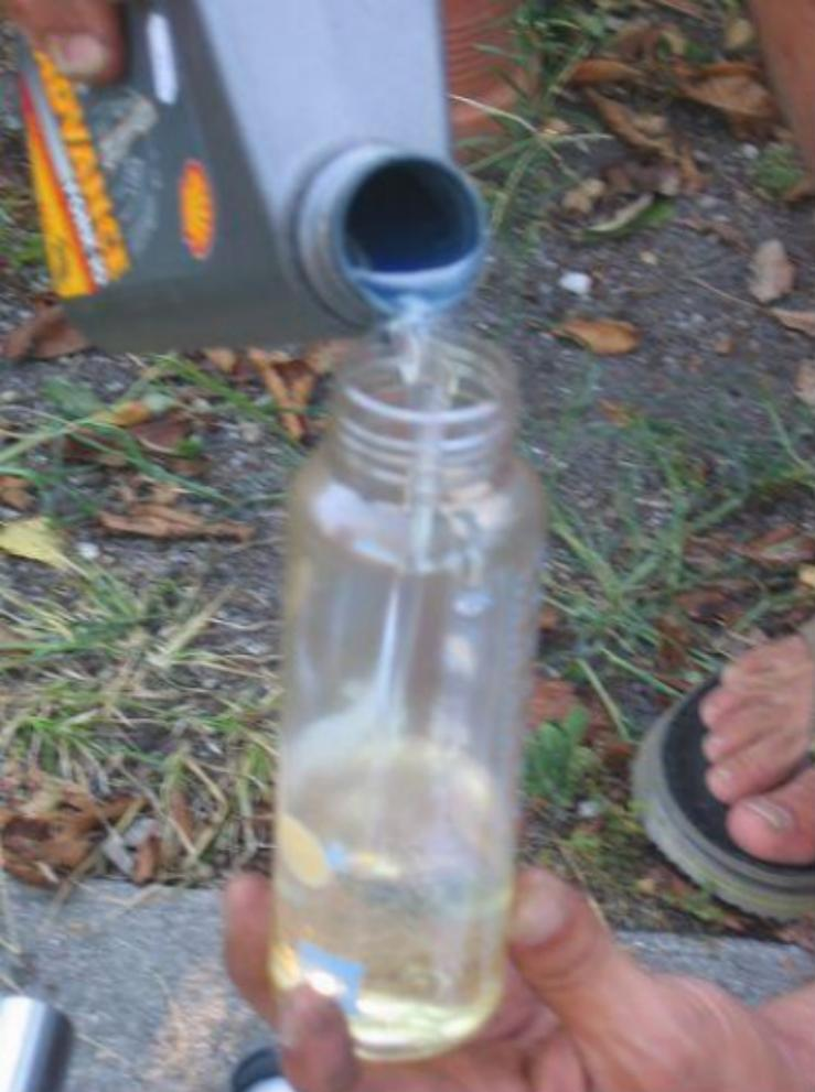
**Préparer dans un récipient gradué la quantité nécessaire d'huile neuve (243 ml pour une TW 125, 238 ml pour une TW 200). Procéder au remplacement de l'huile. Remettre en place les pièces du tube dans l'ordre suivant : ressort, rondelle, cale, bouchon. Visser le bouchon sans le serrer (le serrage final ne pourra se faire que tube bloqué par les tés). Réengager les soufflets de fourche.**
