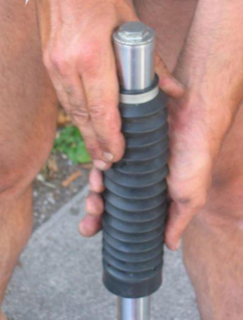
**. Remettre en place les pièces du tube dans l'ordre suivant : ressort, rondelle, cale, bouchon. Visser le bouchon sans le serrer (le serrage final ne pourra se faire que tube bloqué par les tés). Réengager les soufflets de fourche.**
