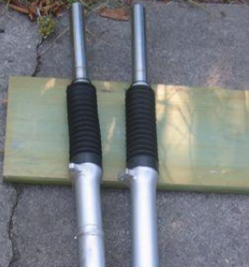
**Desserrer les écrous de 12 sur le té de fourche inférieur pour libérer les tubes et les tirer vers le bas en les faisant pivoter.**
