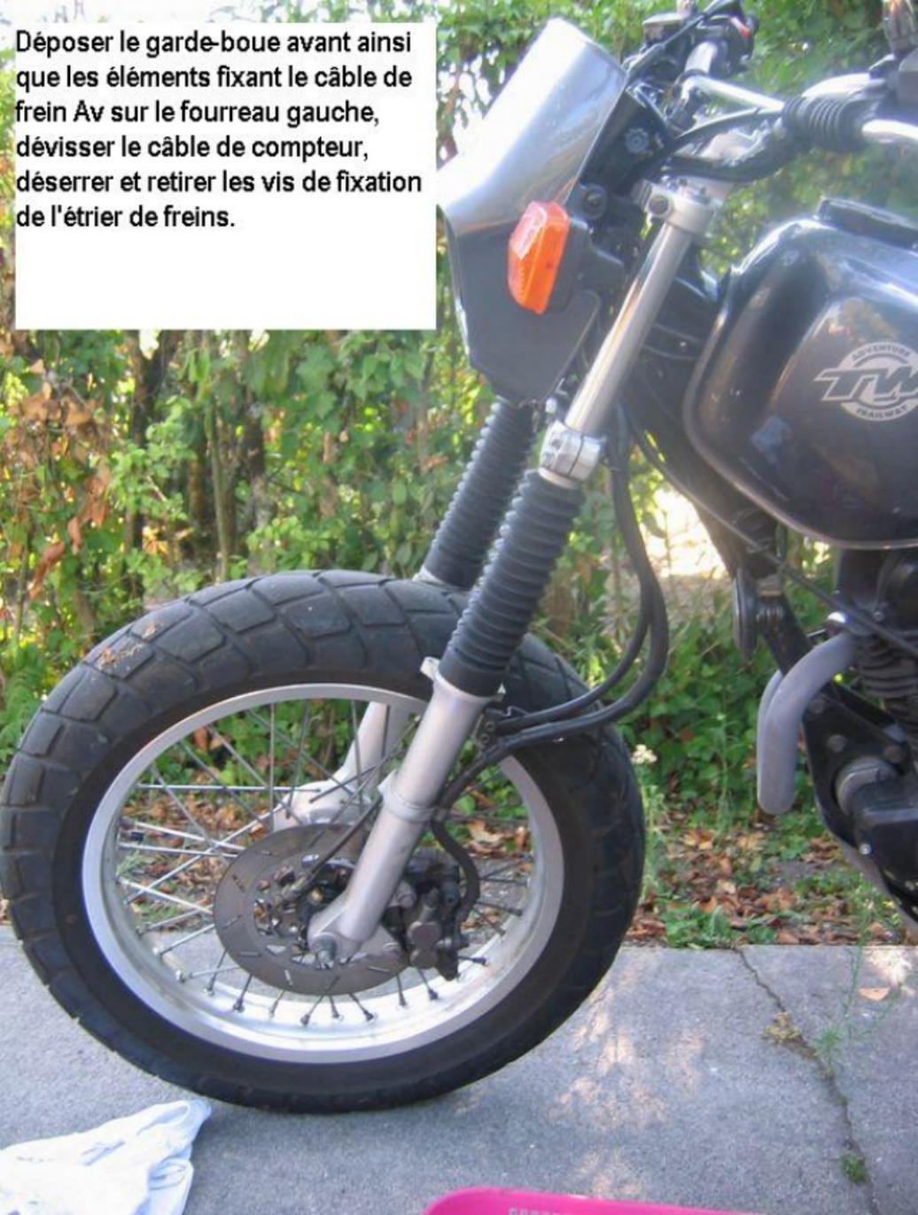
Déposer le garde-boue avant ainsi que les éléments fixant le câble de frein Av sur le fourreau gauche, dévisser le câble de compteur, desserrer et retirer les vis de fixation de l'étrier de freins.
