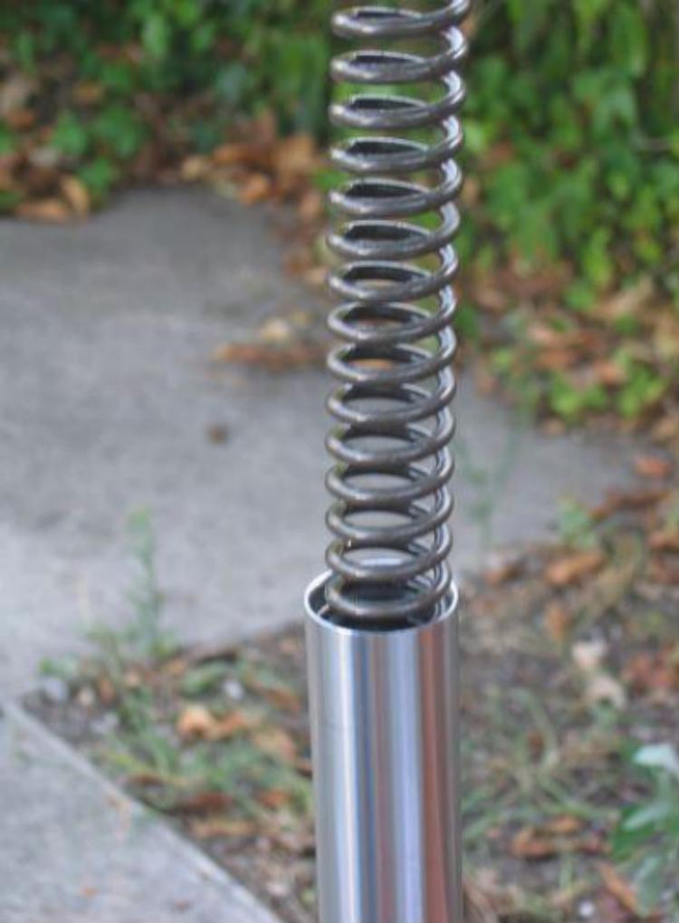
**Remettre en place les pièces du tube dans l'ordre suivant : ressort, rondelle, cale, bouchon. Visser le bouchon sans le serrer (le serrage final ne pourra se faire que tube bloqué par les tés). Réengager les soufflets de fourche.**
