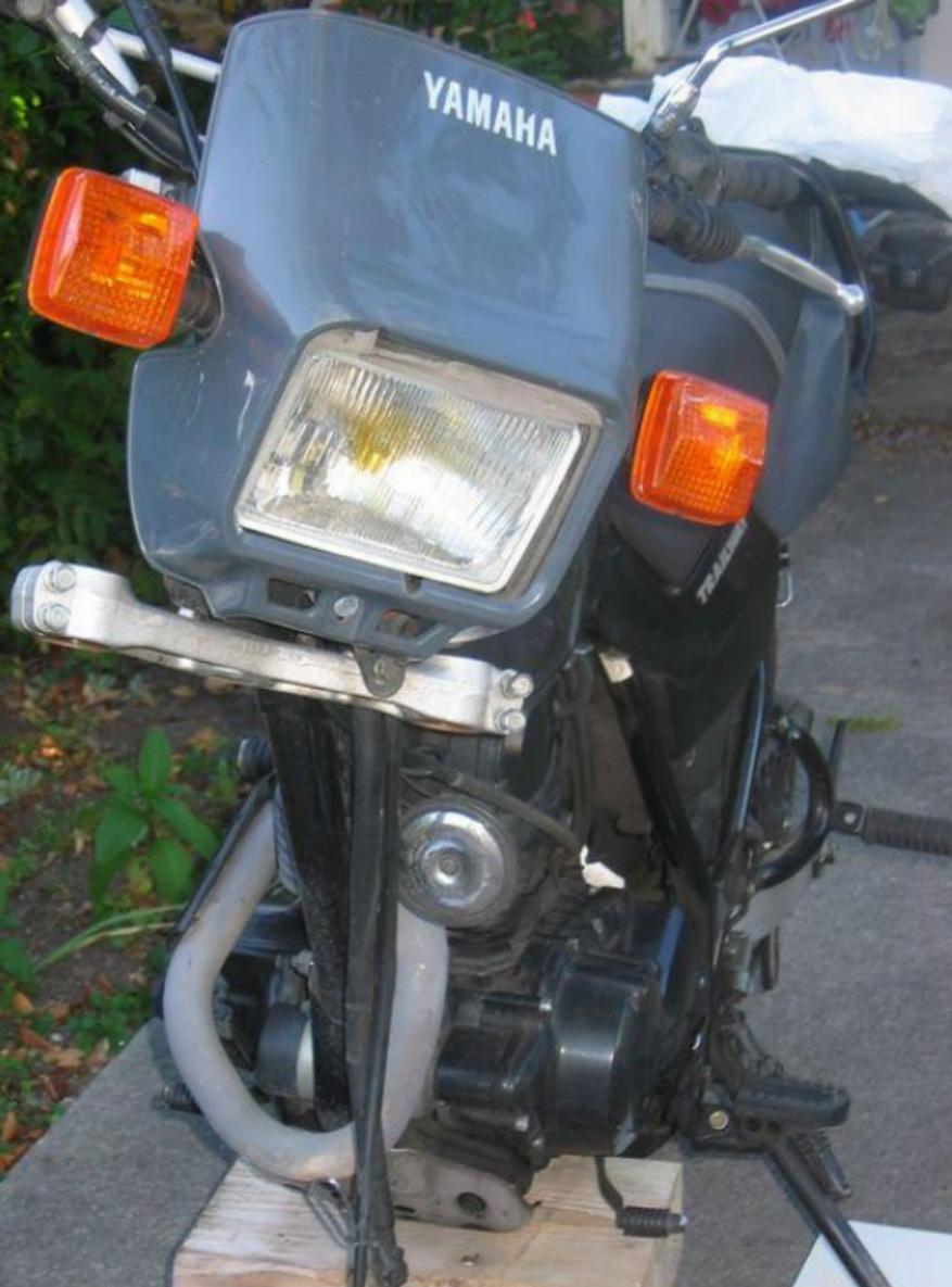
**Desserrer les écrous de 12 sur le té de fourche inférieure pour libérer les tubes et les tirer vers le bas en les faisant pivoter.**
