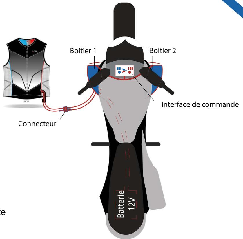
Une interface de commande vous permettra d'atteindre la température souhaitée à tout moment. Le système vous proposera une plage de fonctionnement étendue allant de 18 à 38°. Pour assurer son bon fonctionnement, son utilisation se fera par des températures comprises entre -10°C et 45°C.
