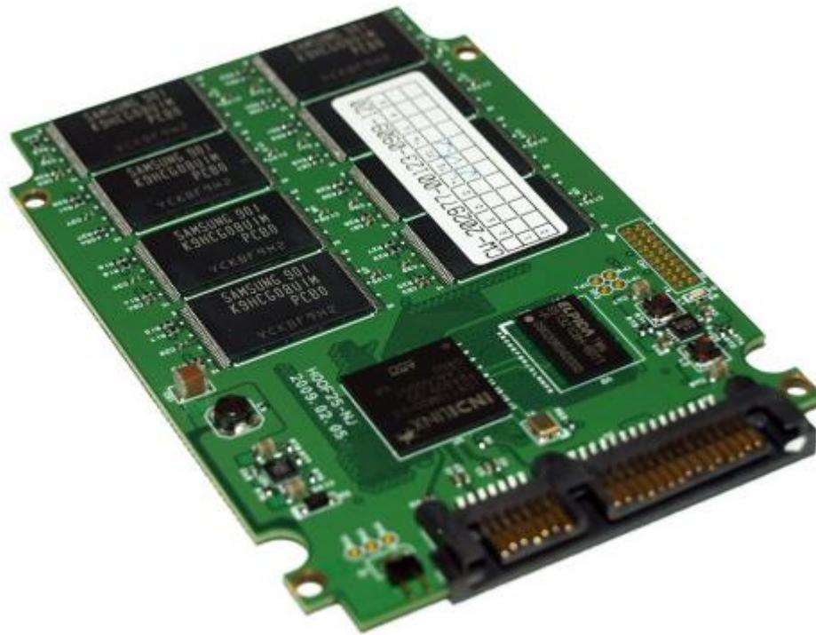
Comme vous pouvez le constater, l'intérieur d'un disque dur SSD n'a rien à voir avec celui d'un disque dur mécanique. Il n'y a plus de plateaux tournants ni de têtes de lecture, tout cela est remplacé par des composants électroniques.
