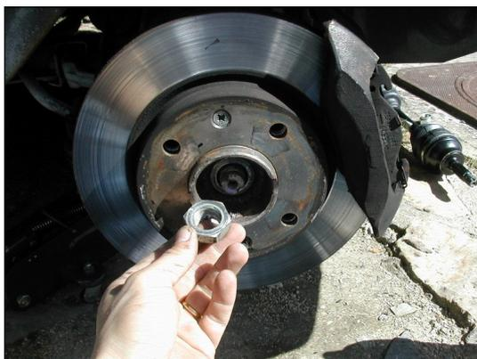
Une fois que l'écrou a sauté, on relève la voiture, on retire la roue de secours pour dégager, et on attaque la vis de maintien de la tête de triangle.
