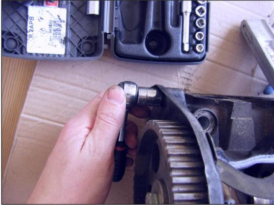
Enlever les paliers et soulever l'arbre à cames côté par côté afin de décoller les paliers récalcitrants.
