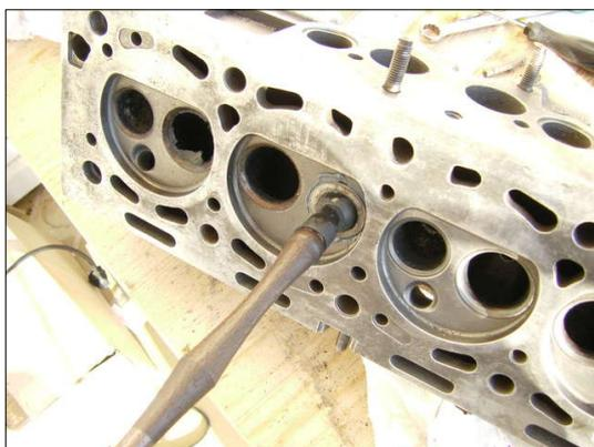
Maintenant, il faut des rotations d'environ un tour en alternant le sens tout en appuyant légèrement sur la soupape pendant 30 secondes. Après sortez la soupape et nettoyez avec un chiffon imbibé d'essence et un petit coup de chiffon sec pour séchez.
