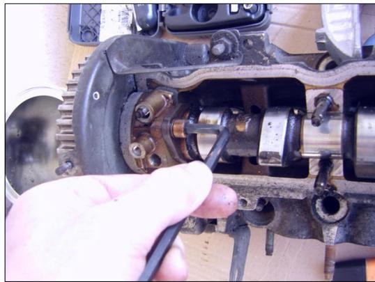
Dévisser les deux boulons qui maintiennent le capotage de la poulie d'A.A.C.
