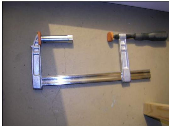
Appliquer la douille sur le "bloc ressort" et mettre le serre joint entre la douille et la soupape à enlever. On serre, ça se débloque et il faut enlever les demis cônes. Desserrage pour enlever l'ensemble ressort et soupapes.
