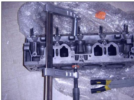
Voici l'ensemble d'un cylindre. Vous remarquerez qu'il y a une rondelle fine au fond du puit où le ressort vient s'appuyer sur la culasse. Si vous réussissez à l'enlever c'est mieux.
