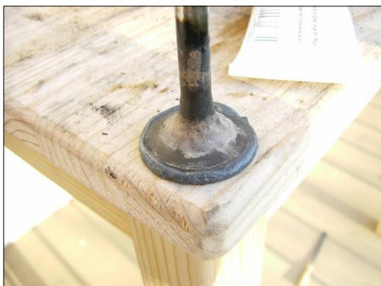
Huilez généreusement la queue de la soupape et introduisez là dans le guide **son** soupape.
