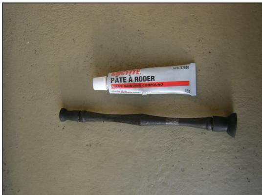
Prenez une soupape que vous aurez nettoyée (laisser mariner dans le substitut du trychlo quelques jours et essuyez.) et mettez de la pâte à roder sur le bord de la tulipe (portée de joint de la soupape).
