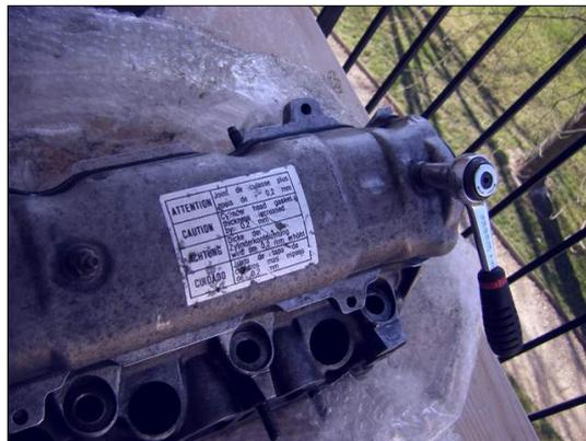
Ensuite, tirer la rampe de graissage et dévisser les paliers d'arbre à cames avec du 10.
