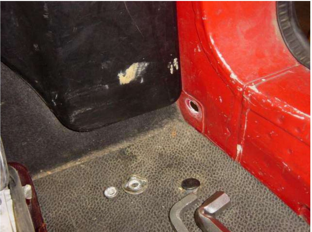
Le pare-chocs arrière tenu avec deux vis depuis le coffre...
