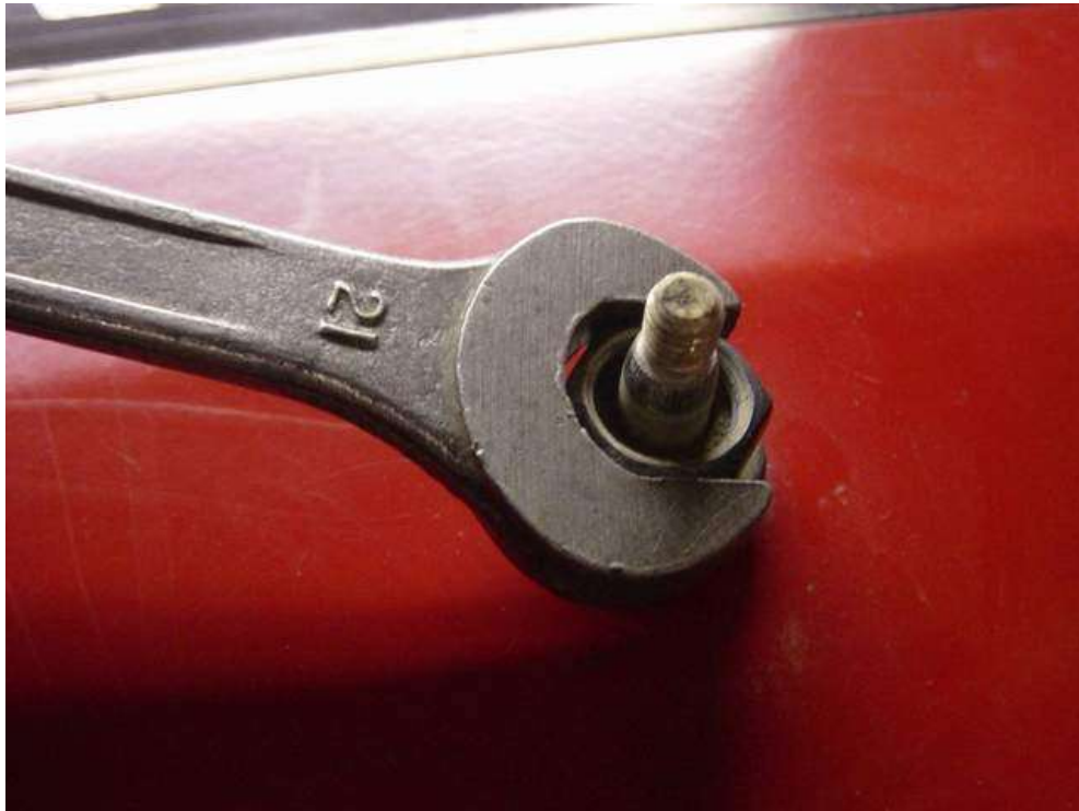
Le moteur d'essuie-glace arrière maintenu au niveau de son axe par un écrou en plastique de 21..
