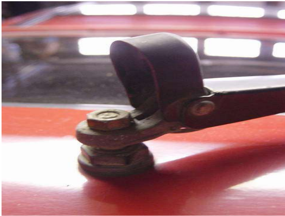
Le moteur d'essuie-glace arrière maintenu au niveau de son axe par un écrou en plastique de 21..
