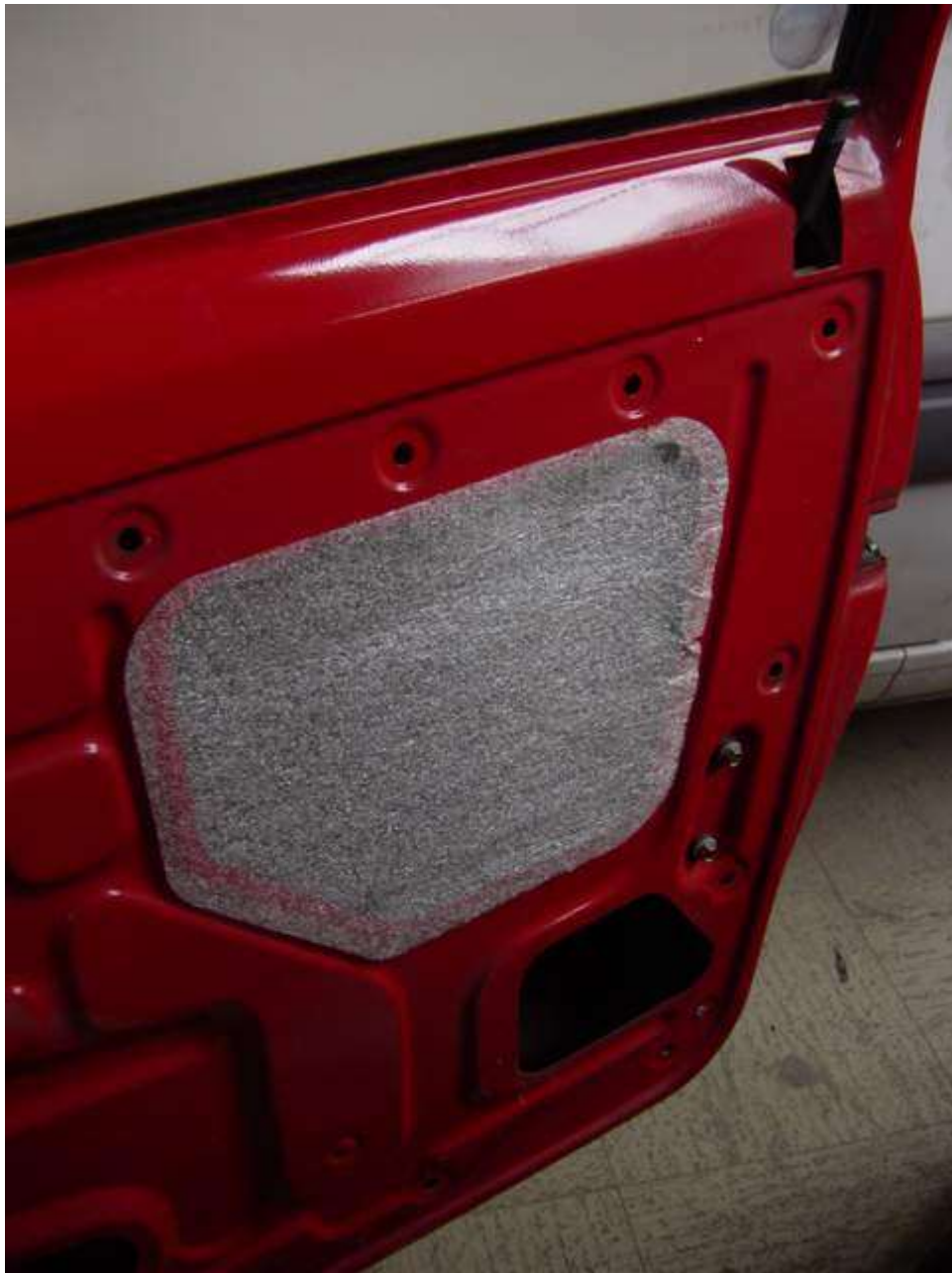
La poignée tenue avec un écrou de l'intérieur et une vis torx de l'extérieur
