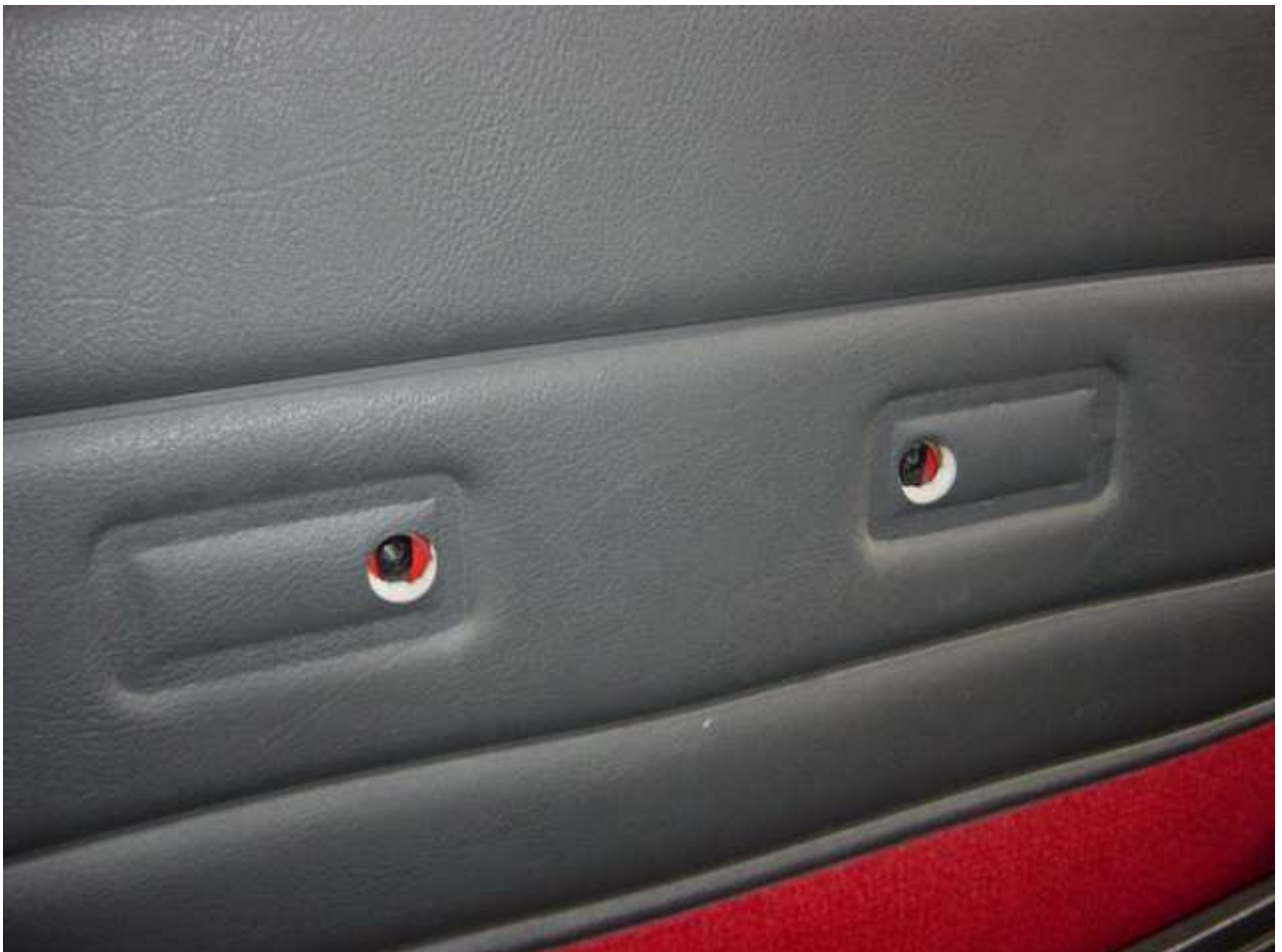
L'enjoliveur de la poignée intérieure juste à déclipser avec un tournevis plat
