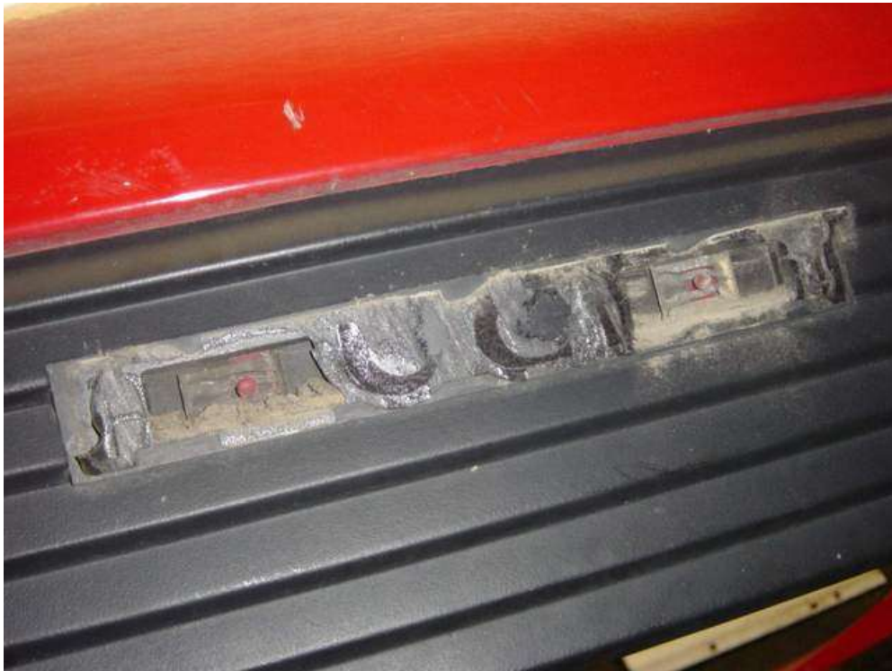
La serrure du coffre qu'il faut déclipser de l'intérieur
