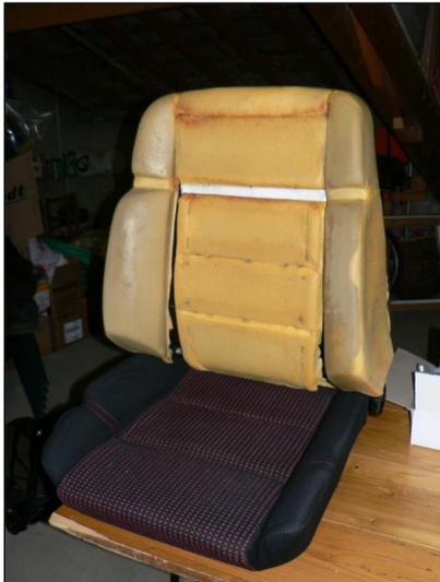
Pour les chainettes, au lieu de les fixer comme à l'origine avec des agrafes sur la mousse, au risque de la déchirer, j'ai préféré la tendre avec du petit fil de fer dans un premier temps puis je l'ai accroché à l'armature dans un second temps...
