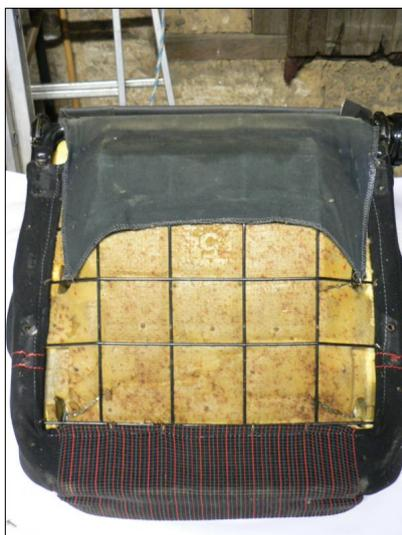
On peut voir sur la photo que la housse est maintenue par des anneaux (c'est pour cela que dans le matériel, on retrouve une pince à grillage... ce sera plus pratique pour les re-fixer une fois l'opération finie).
