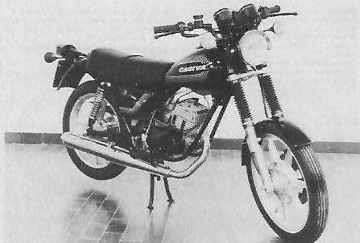
**Moteur :** 2 temps, monocylindre, alésage et course 56 mm x 50 mm, cylindrée 123,1 cm<sup>3</sup>, compression 10,8 à 1, puissance 17 ch à 6 750 tr/mn, couple maximum 1,2 m/kg à 6 750 tr/mn, carburateur Dell'Orto Ø 27 mm, allumage volant magnétique, lubrification par pompe à huile, mise en route par kick primaire.
