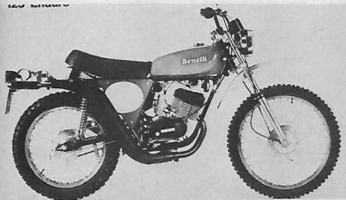
**Moteur :** 2 temps, monocylindre, alésage et course 49 mm x 56 mm, cylindrée 121 cm<sup>3</sup>, compression 9,5 à 1, puissance 15,4 ch SAE à 7 800 tr/mn, couple maximum 1,2 m/kg à 5 950 tr/mn, carburateur Dell'Orto Ø 22 mm, allumage volant magnétique, lubrification par mélange à 3 %, mise en route par kick.
