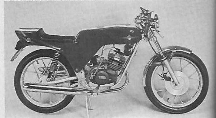
**Moteur :** 2 temps, monocylindre, alésage et course 42 mm x 38,8 mm, cylindrée 49,6 cm<sup>3</sup>, compression 11,3 à 1, puissance 2,4 ch, carburateur SHA Ø 14-12 mm, allumage volant magnétique, lubrification par mélange à 5 %, mise en route par kick.
