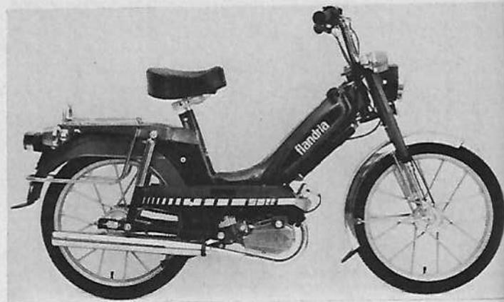
**Moteur :** 2 temps, monocylindre, alésage et course 40 mm x 39,7 mm, cylindrée 49,7 cm<sup>3</sup>, compression 7 à 1, puissance 2 ch à 5 000 tr/mn, couple maximum 0,32 m/kg à 4 000 tr/mn, carburateur S 33 Ø 12 mm, allumage volant magnétique, lubrification par mélange à 5 %, mise en route par rétrokick.
