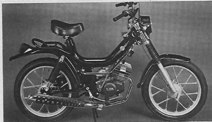
**Moteur :** 2 temps, monocylindre, alésage et course 42 mm x 38,8 mm, cylindrée 49,6 cm<sup>3</sup>, compression 9 à 1, puissance 2 ch, carburateur SHA Ø 14-12 mm, allumage volant magnétique, lubrification par mélange à 5 %, mise en route par kick.
