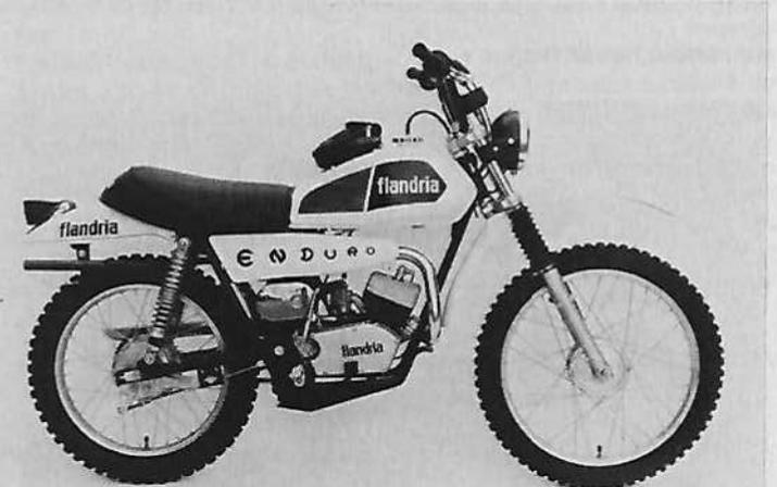
**Moteur :** 2 temps, monocylindre, alésage et course 40 mm x 39,7 mm, cylindrée 49,7 cm<sup>3</sup>, compression 6,8 à 1, puissance 2,2 ch à 5 300 tr/mn, couple maximum 0,32 m/kg à 4 000 tr/mn, carburateur SHA 14-12 Ø 12 mm, allumage volant magnétique 6 V, lubrification par mélange à 5 %, mise en route par pédales.
