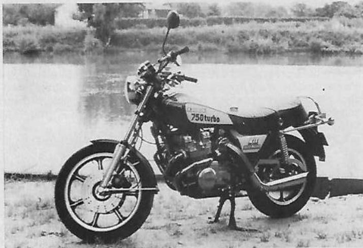
**Moteur :** 4 temps, 4 cylindres, alésage et course 66,5 mm x 54 mm, cylindrée 738 cm<sup>3</sup>, compression 6,8 à 1, puissance 115 ch à 10 000 tr/mn, couple maximum 9 m/kg à 8 000 tr/mn, 1 carburateur Ø 42 mm, alimentation forcée par turbo compresseur.
