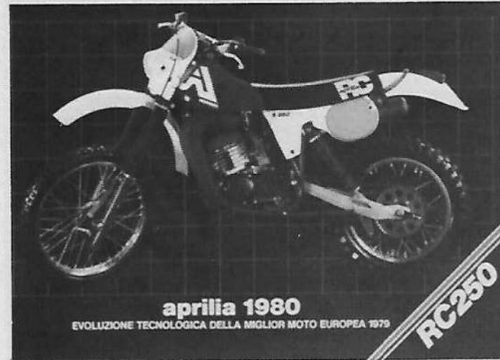
**Moteur :** Hiro, 2 temps, monocylindre, alésage et course 71 mm × 60 mm, cylindrée 238 cm<sup>3</sup>, compression 11,5 à 1, puissance 38 ch à 7 800 tr/mn, carburateur Dell'Orto PHBE 36, allumage électronique Motoplat, lubrification par mélange à 5 %, mise en route par kick.
