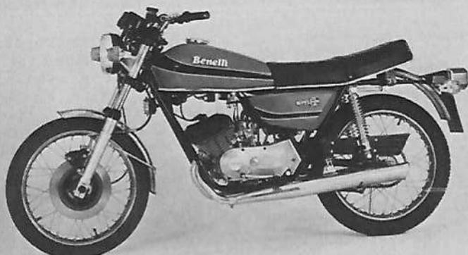
**Moteur :** 2 temps, bicylindre, alésage et course 42,5 mm x 44 mm, cylindrée 124,77 cm<sup>3</sup>, compression 10,3 à 1, puissance 17 ch à 8 100 tr/mn, 2 carburateurs Dell'Orto Ø 19 mm, allumage électronique, lubrification par mélange à 3 %, mise en route par kick.
