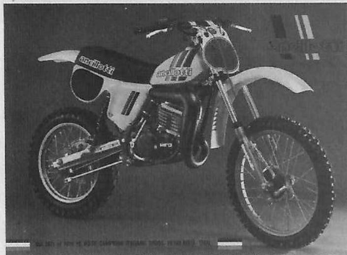
**Moteur :** Hiro « 6 transferts », 2 temps, monocylindre, alésage et course 72 x 60 mm, cylindrée 237 cm<sup>3</sup>, compression 11,5 à 1, puissance 36 ch à 10 600 tr/mn, carburateur Dell'Orto PHB 36 en magnésium, allumage Motoplaf électronique, lubrification par mélange, mise en route par kick.
