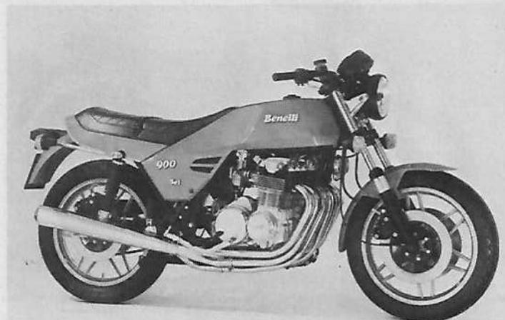
**Moteur** : 4 temps, 6 cylindres, cylindrée 906 cm<sup>3</sup>, puissance 80 ch à 8 400 tr/mn, 3 carburateurs Dell'Orto, allumage électronique, mise en route par kick + démarreur électrique.
