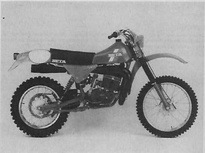
**Moteur :** chemisé, cylindre en alliage, en fonte traitée, culasse en alliage léger, carburateur avec diffuseur Ø 38 mm, alésage et course 74 x 81 mm, cylindrée 348 cc, rapport de compression 11 à 1, reed valve, puissance maxi 48 ch à 7 000 tr/mn, filtre à cartouche lavable, allumage électronique, embrayage à disques en bain d'huile, transmission primaire à engrenages à taille droite, boîte à 6 vitesses (2,428, 1,611, 1,181, 0,953, 0,807, 0,655).
