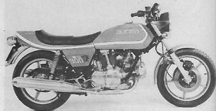
**Moteur :** 4 temps, bicylindre, alésage et course 86 mm x 74,4 mm, cylindrée 864 cm3, compression 9,4 à 1, 2 carburateurs Dell'Orto PHF Ø 32 mm, allumage électronique, lubrification par pompe à huile et carter humide, mise en route par kick et démarreur électrique.
