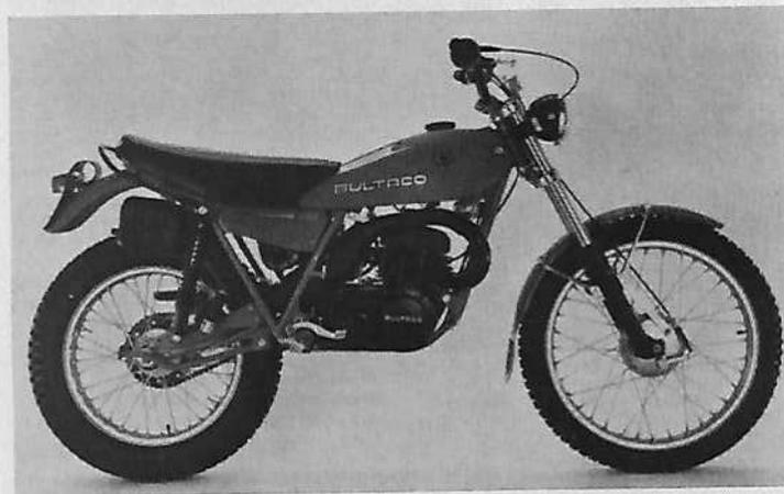
**Moteur :** 2 temps, monocylindre, alésage et course 70 mm x 64 mm (85 mm x 64 mm), cylindrée 246,3 cm<sup>3</sup> (363,2 cm<sup>3</sup>), compression 11 (10) à 1, puissance 38,8 ch à 8 700 tr/mn (42,2 ch à 8 000 tr/mn), carburateur Bing Ø 38 mm, (40 mm), allumage électronique Motoplat, lubrification par mélange, mise en route par kick.
