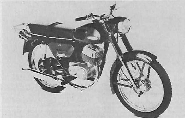
**Moteur :** 2 temps, monocylindre, alésage et course 52 mm x 58 mm, cylindrée 123 cc, puissance 9,5 BHP à 6 000 tr/mn, allumage volant magnétique, lubrification par mélange à 4 %, mise en route par kick.
