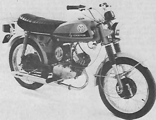
**Moteur :** 2 temps, monocylindre, alésage et course 40 mm x 39,7 mm, cylindrée 49,9 cm<sup>3</sup>, compression 8,5 à 1, puissance 6,5 ch à 8 500 tr/mn, couple maximum 0,6 m/kg à 8 000 tr/mn, carburateur Bing Ø 17 mm, allumage Bosch 6 V 17 W, lubrification par mélange, mise en route par kick.
