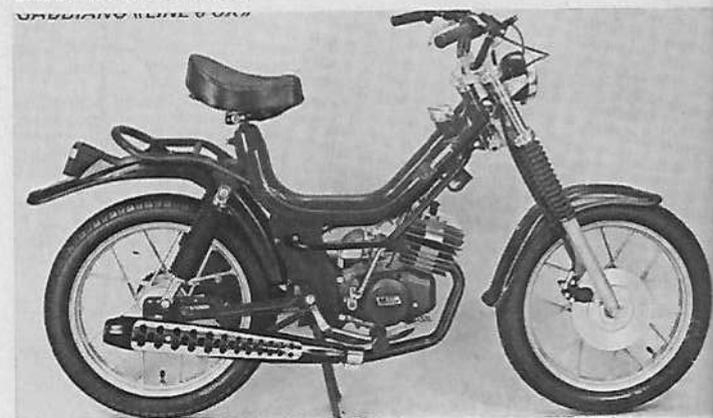
**Moteur :** 2 temps, monocylindre, alésage et course 42 mm x 38 mm, cylindrée 49,6 cm<sup>3</sup>, compression 11,3 à 1, puissance 2,4 ch, carburateur SHA Ø 14-12 mm, allumage volant magnétique, lubrification par mélange à 5 %, mise en route par kick.
