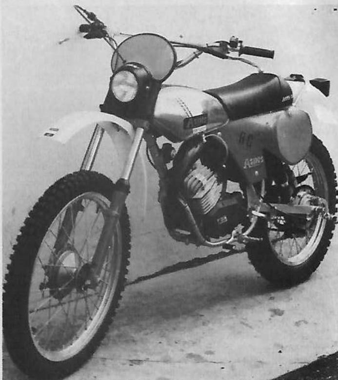
**Moteur :** Minarelli radial, 2 temps, monocylindre, alésage et course 38,8 mm x 42 mm, cylindrée 49,6 cm<sup>3</sup>, compression 11 à 1, puissance 13,5 ch, carburateur Dell'Orto Ø 35 mm, allumage électronique, lubrification par mélange, mise en route par kick.
