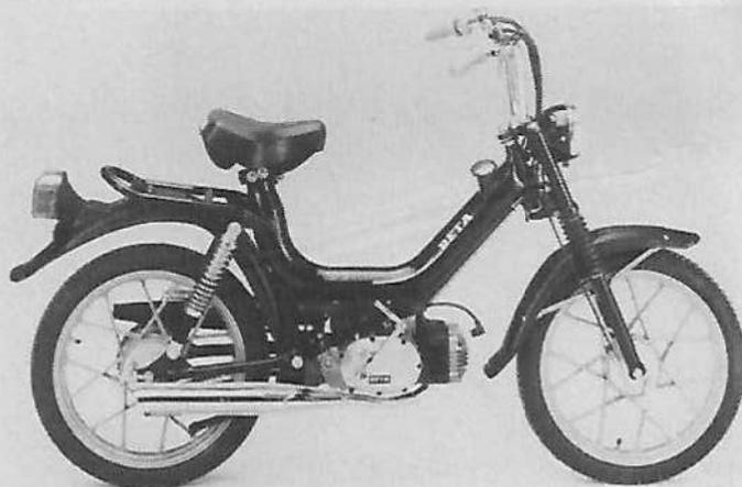
**Moteur :** 2 temps, alésage et course 40 mm x 39 mm, cylindrée 49 cc, alimentation par mélange huile/essence à 3 %, carburateur Dell'Orto, allumage par volant magnétique.
