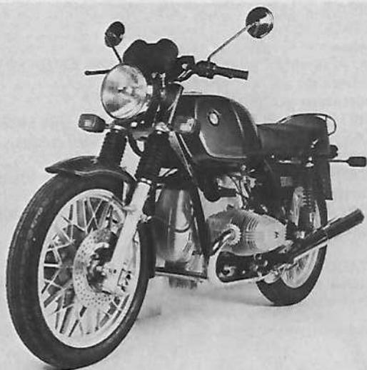
**Moteur :** 4 temps, 2 cylindres, alésage et course 84,8 mm x 70,6 mm, cylindrée 785 cm<sup>3</sup>, compression 8 à 1, puissance 55 ch à 7 000 tr/mn, couple maximum 6,4 m/kg à 5 500 tr/mn, 2 carburateurs Bing Equipression Ø 40 mm, allumage batterie - bobine, lubrification sous pression, mise en route par démarreur électrique.
