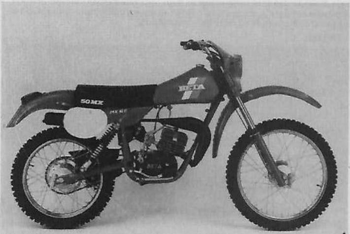
**Moteur :** Beta, cylindre aluminium, culasse à filetage radial, cylindrée 48,8 cc, alésage et course 38 x 44 mm, compression 8,5 à 1, boîte de vitesses à 6 rapports, transmission primaire par engrenages, secondaire par chaîne, carburateur Dell'Orto.
