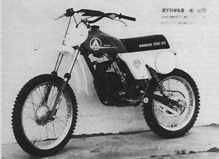
**Moteur :** monocylindre 2 temps, alésage et course 38,8 mm x 42 mm, cylindrée 49,6 cm<sup>3</sup>, compression 11 à 1, puissance 13 ch à 5 500 tr/mn, carburateur Dell'Orto, allumage électronique, lubrification par mélange, mise en route par kick.
