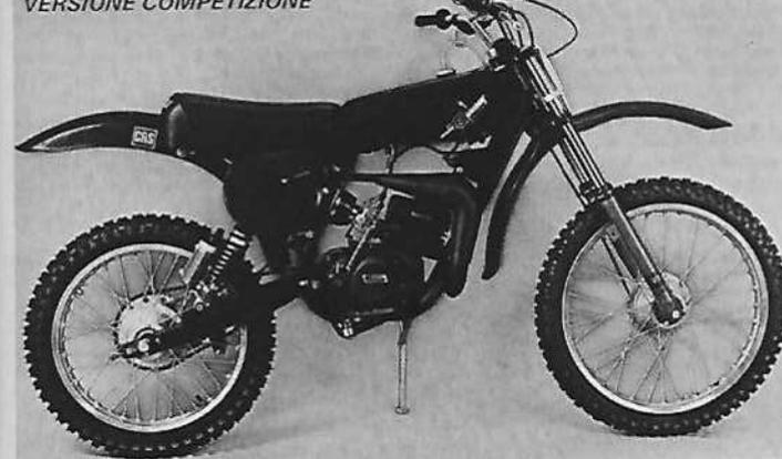
**Moteur :** 2 temps, monocylindre, alésage et course 40,3 mm x 39 mm, cylindrée 49,72 cm<sup>3</sup>, compression 14 à 1, puissance 12 ch à 13 000 tr/mn, carburateur PHBG Ø 18 mm, allumage électronique, lubrification par mélange à 4 %, mise en route par kick.
