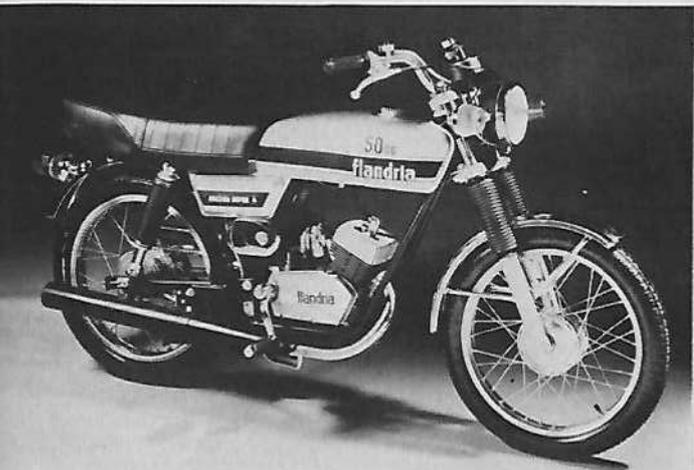
**Moteur :** 2 temps, monocylindre, alésage et course 40 mm x 39,7 mm, cylindrée 49,7 cm<sup>3</sup>, compression 6,8 à 1, puissance 2,5 ch à 5 300 tr/mn, couple maximum 0,33 m/kg à 4 000 tr/mn, carburateur SHA 14-9 Ø 9 mm, allumage volant magnétique 6 V, lubrification par mélange à 5 %, mise en route par pédales.
