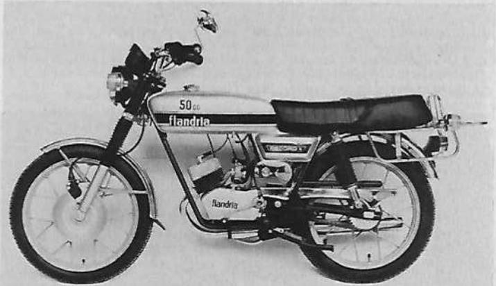
**Moteur :** 2 temps, monocylindre, alésage et course 40 mm x 39,7 mm, cylindrée 49,7 cm<sup>3</sup>, compression 6,8 à 1, puissance 2,5 ch à 5 300 tr/mn, couple maximum 0,33 m/kg à 4 000 tr/mn, carburateur SHA 14-12 Ø 12 mm, allumage volant magnétique 6 V, lubrification par mélange à 5 %, mise en route par pédales.
