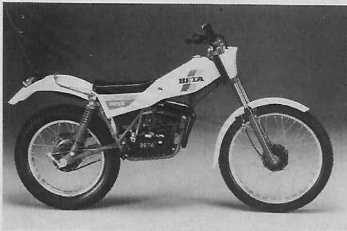
**Moteur :** Beta 49 cc, cylindre chromé, alésage et course 40 x 39,7 mm, volant suralourdi pour augmenter la souplesse, culasse à filetage radial, engrenages par roulements à rouleaux.
