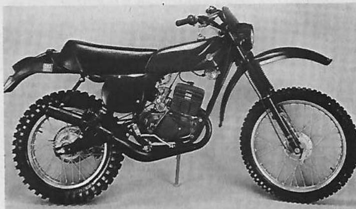
**Moteur :** Minarelli, 2 temps, monocylindre, alésage et course 55 mm x 52 mm, cylindrée 123,48 cm<sup>3</sup>, compression 9,35 à 1, puissance 22 ch à 10 500 tr/mn, carburateur Dell'Orto PHB Ø 32 mm, allumage électronique, lubrification par mélange à 5 %, mise en route par kick.
