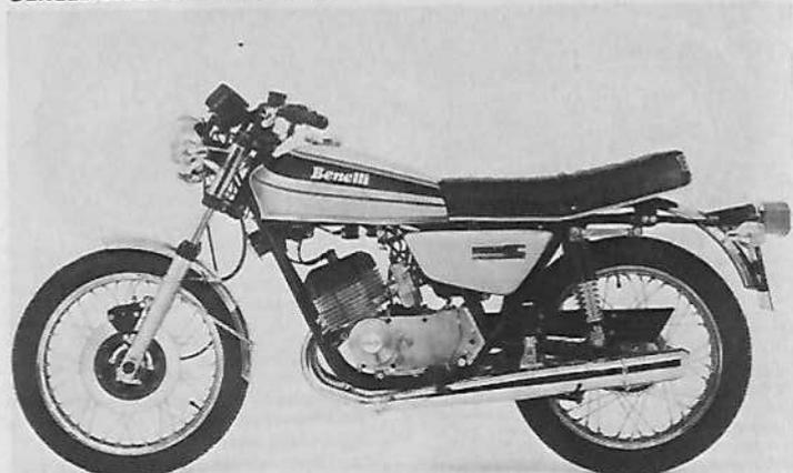
**Moteur :** 2 temps, bicylindre, alésage et course 56 mm x 47 mm, cylindre 231,4 cm<sup>3</sup>, compression 10 à 1, puissance 30 ch à 8 000 tr/mn, couple maximum 2,9 m/kg à 7 300 tr/mn, 2 carburateurs Dell'Orto Ø 25 mm, allumage électronique, lubrification par mélange à 3 %, mise en route par kick.
