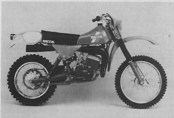
**Moteur :** cylindre aluminium, carburateur Ø 36 mm, admission par clapets, 40 cv à 7 500 tr/mn, 6 vitesses.
