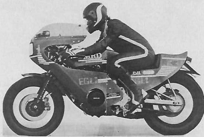
**Moteur :** 4 temps, 4 cylindres, alésage 75 mm, cylindrée 1 170 cm<sup>3</sup>, compression 8 à 1, puissance 168 ch à 9 800 tr/min, carburateur Ø 45 mm, allumage électronique, lubrification par pompe, mise en route par démarreur électrique.
