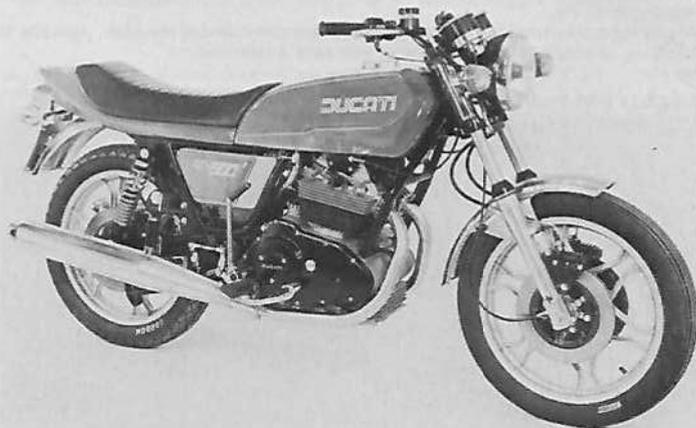
**Moteur :** 4 temps, bicylindre, alésage et course 78 mm x 52 mm, cylindrée 496,9 cm<sup>3</sup>, compression 10 à 1, puissance 33,65 ch à 6 500 tr/mn, couple maximum 3,91 m/kg à 5 500 tr/mn, 2 carburateurs Dell'Orto Ø 30 mm, allumage batterie - bobine, lubrification par pompe à haute pression, mise en route par kick + démarreur électrique.
