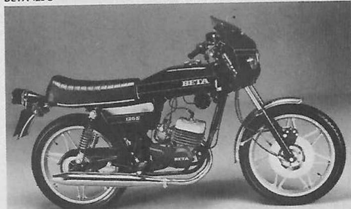
**Moteur :** 2 temps, alésage et course 54 x 54 mm, cylindrée 123,6 cc, cylindre en alliage léger, fonte traitée, allumage électronique, embrayage à disques multiples en bain d'huile, boîte 6 vitesses, et engrenages sur cage à rouleaux, carburateur Dell'Orto, bougies Champion N 84 G.
