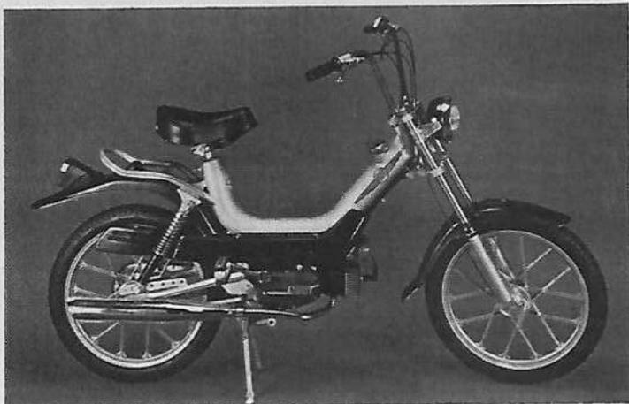
**Moteur :** 2 temps, monocylindre, alésage et course 42 mm x 38,8 mm, cylindrée 49,6 cm<sup>3</sup>, compression 8 à 1, puissance 2 ch, carburateur SHA Ø 14-12 mm, allumage volant magnétique, lubrification par mélange à 3 %, mise en route pédales.
