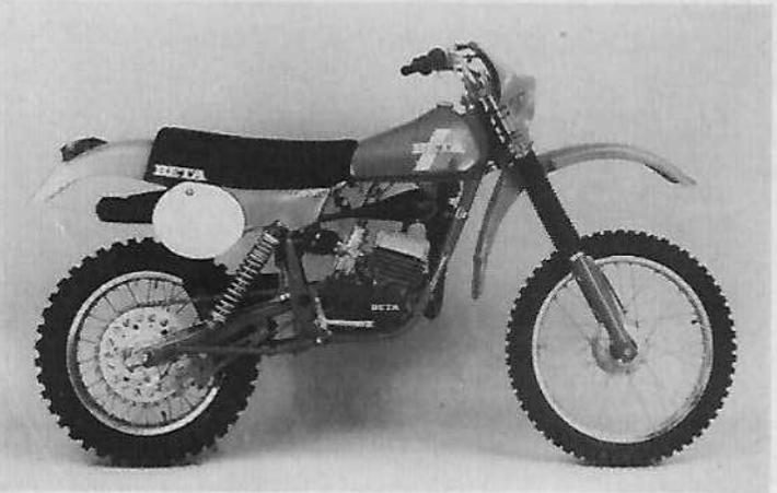
**Moteur :** 2 temps, cylindre en alliage léger, fonte traitée, culasse en alliage léger, alésage et course 54 x 54 mm, rapport de compression 1 à 13, carburateur concentrique avec diffuseur Ø 34 mm, filtre à cartouche lavable, allumage électronique, embrayage à disques en bain d'huile, transmission primaire à engrenages à taille droite, boîte 6 vitesses (3,181, 2,066, 1,611, 1,300, 1,043, 0,840), bougie CW P 112L Marelli.
