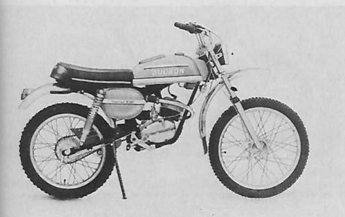
**Moteur :** 2 temps, monocylindre, alésage et course 40 mm x 39 mm, cylindrée 49 cm<sup>3</sup>, compression 10 à 1, puissance 1,5 ch à 5 000 tr/min, carburateur Ø 12 mm, allumage volant magnétique, lubrification par mélange à 3 %, mise en route par kick.
