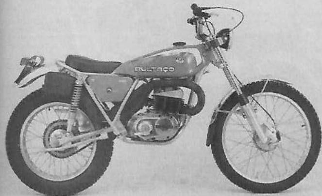
**Moteur :** 2 temps, monocylindre, alésage et course 71 mm x 60 mm, cylindrée 237,56 cm<sup>3</sup>, compression 9 à 1, puissance 14,1 ch à 5 500 tr/mn, couple maximum 2,04 m/kg à 4 000 tr/mn, carburateur Amal Ø 27 mm, allumage magnéto-alternateur à volant avec rupteur, lubrification par mélange, mise en route par kick.
