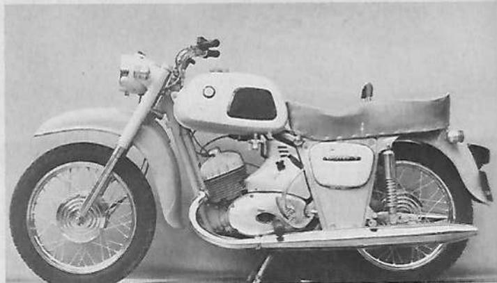
**Moteur :** 2 temps, bicylindre, admission classique, alésage et course 61,7 mm x 58 mm, cylindrée 347 cc, compression 8,5 à 1, puissance env. 27 ch à 4 600 tr/mn, carburateurs sous carter, filtres à bain d'huile, 2 type K36J, allumage par batterie-bobines, dynamo 6 V 45 W, lubrification par mélange à 4 %, mise en route par kick.
