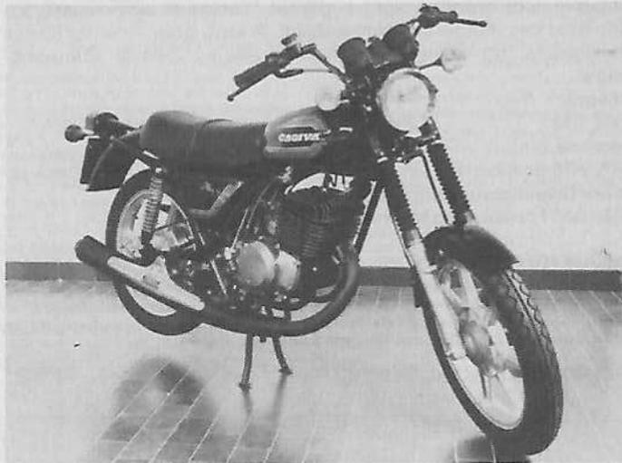
**Moteur :** 2 temps, monocylindre, alésage et course 80 mm x 64 mm, cylindrée 342 cm<sup>3</sup>, compression 9,6 à 1, puissance 25,5 ch à 5 750 tr/mn, carburateur Dell'Orto Ø 34 mm, allumage électronique, lubrification par mélange, mise en route par kick.
