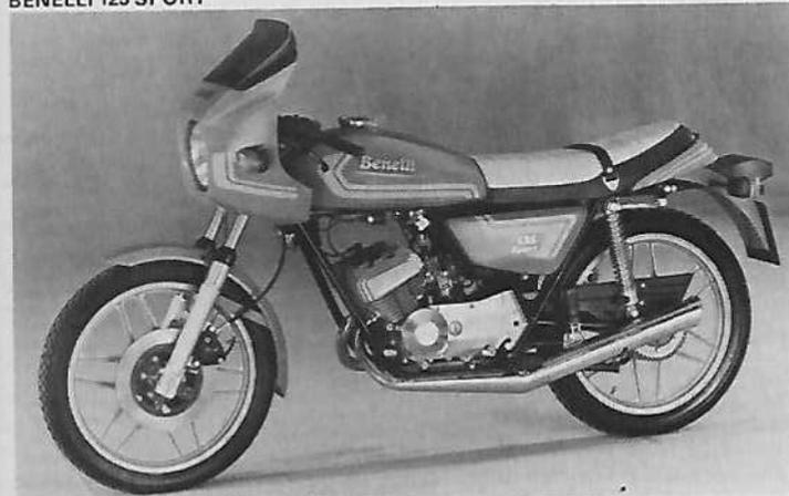
**Moteur :** 2 temps, bicylindre, alésage et course 42,5 mm x 44 mm, cylindrée 124,77 cm<sup>3</sup>, compression 10,3 à 1, puissance 18 ch à 8 100 tr/mn, 2 carburateurs Dell'Orto Ø 19 mm, allumage électronique, lubrification par mélange à 3 %, mise en route par kick.
