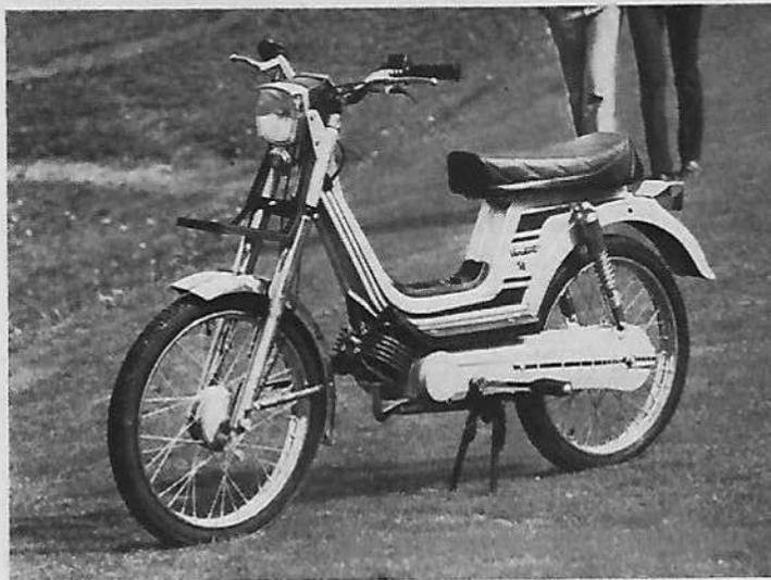
**Moteur :** 2 temps, monocylindre, alésage et course 38 mm x 43 mm, cylindrée 48,767 cm<sup>3</sup>, compression 9 à 1, carburateur Dell'Orto, allumage volant magnétique, lubrification par mélange, mise en route par pédales.
