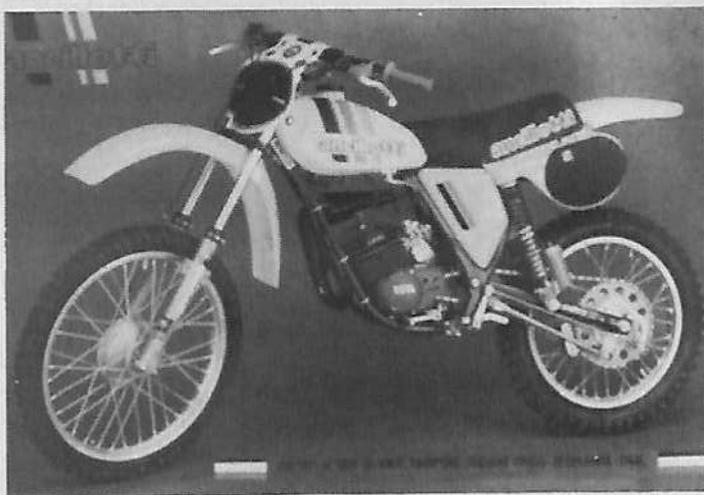
**Moteur :** Minarelli « course courte », 2 temps monocylindre, alésage et course 39 x 40,3 mm, cylindrée 49 cm<sup>3</sup>, puissance 12,2 ch à 13 800 tr/mn, carburateurs Dell'Orto 28 mm (enduro 26 mm), allumage électronique Motoplast, lubrification mélange, mise en route kick.
