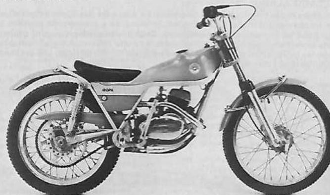
**Moteur :** 2 temps, monocylindre, alésage et course 70 mm x 64 mm (85 mm x 64 mm), cylindrée 246,3 cm<sup>3</sup> (363,2 cm<sup>3</sup>), compression 11 (10) à 1, puissance 37,4 ch à 8 720 tr/mn, (42,2 ch à 7 500 tr/mn) carburateur Bing 54 Ø 36 mm, allumage volant magnétique, lubrification par mélange, mise en route par kick.
