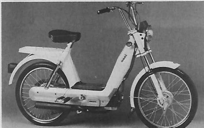
**Moteur :** 2 temps, monocylindre, alésage et course 38,8 mm x 42 mm, cylindrée 49,6 cm<sup>3</sup>, compression 8,5 à 1, puissance 1,4 ch à 4 200 tr/mn, régime de couple maximum 3 200 tr/mn, carburateur Dell'Orto Ø 12 mm, allumage volant magnétique, lubrification par mélange à 2 %, mise en route par pédales.
