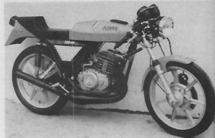
**Moteur :** 2 temps, monocylindre, alésage et course 54 mm × 54 mm, cylindrée 124 cm<sup>3</sup>, compression 10 à 1, puissance 21 ch à 9 500 tr/mn, carburateur Dell'Orto Ø 34 mm, allumage électronique Motoplat, lubrification par mélange à 5 %, mise en route par kick.
