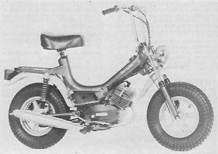
**Moteur :** 2 temps, monocylindre, alésage et course 40 mm x 39 mm, cylindrée 49 cm<sup>3</sup>, compression 8,2 à 1, carburateur Dell'Orto Ø 14 mm, allumage volant magnétique, lubrification par mélange 3 %, mise en route par kick.
