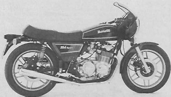
**Moteur** : 4 temps, 4 cylindres, cylindrée 346 cm<sup>3</sup>, compression 10,4 à 1, puissance 38 ch à 10 200 tr/mn, allumage batterie-bobine, lubrification par carter humide, mise en route par kick, + démarreur électrique.
