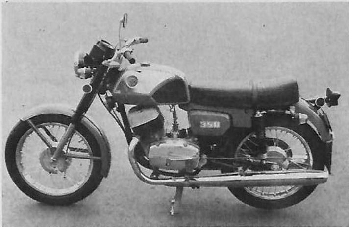
jantes Ø AV 1,85 x 18", Ø AR 2,15 x 18", pneus Ø AV 3,00 x 18", Ø AR 3,25 x 18", freins AV et AR à tambours Ø 160 mm.
