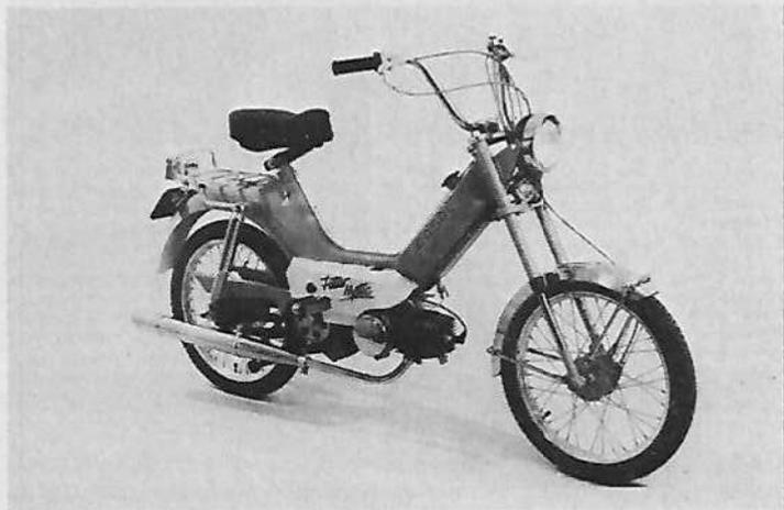
**Moteur :** 2 temps, monocylindre, alésage et course 40 mm x 39,7 mm, cylindrée 49,9 cm<sup>3</sup>, compression 8,5 à 1, puissance 2 ch à 4 500 tr/mn, couple maximum 0,330 m/kg à 4 000 tr/mn, carburateur Bing Ø 12 mm, allumage Bosch 6 V/18 W, lubrification par mélange, mise en route par pédales.
