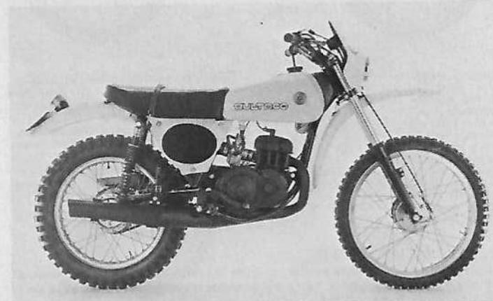
**Moteur :** 2 temps, monocylindre, alésage et course 43 mm x 51,5 mm, cylindrée 74,8 cm<sup>3</sup>, compression 10,5 à 1, puissance 8,8 ch à 8 300 tr/mn, carburateur Bing 84, allumage électronique, lubrification par mélange, mise en route par kick.
