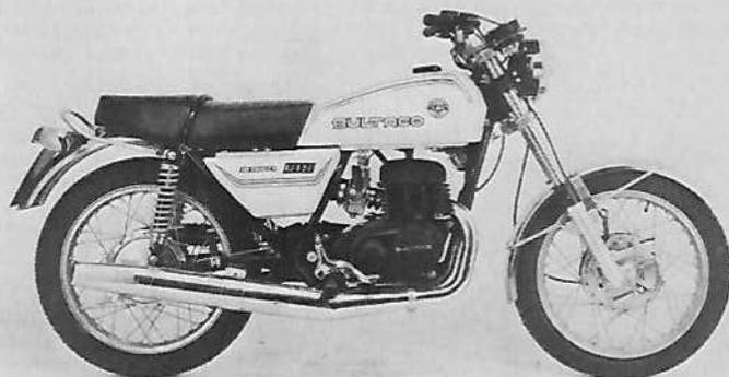
**Moteur :** 2 temps monocylindre, alésage et course 72 mm x 60 mm, cylindrée 244,29 cm<sup>3</sup>, compression 10 à 1, puissance 25 ch à 7 500 tr/mn, carburateur Bing Ø 32 mm, allumage magnéto-alternateur à volant électronique, lubrification par mélange, mise en route par kick.
