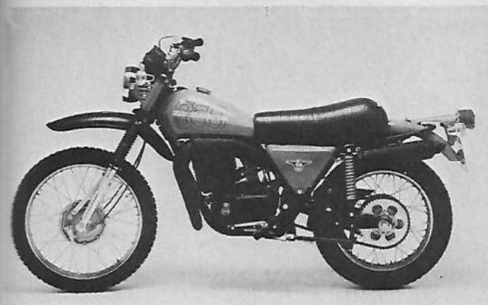
**Moteur :** 2 temps, monocylindre, alésage et course 80 mm x 68 mm, cylindrée 341 cm<sup>3</sup>, compression 9,6 à 1, carburateur Dell'Orto 034 mm, allumage électronique, lubrification par pompe à huile, mise en route par kick primaire.
