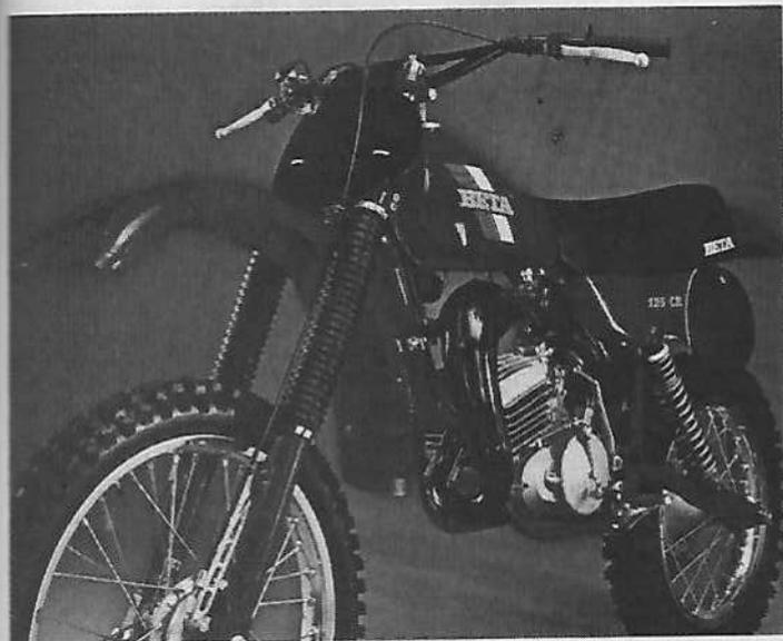
**Moteur :** Cylindre en alliage léger, fonte traitée. Culasse en alliage léger. Carburateur avec diffuseur Ø 36 mm. Alésage et course 54 x 54 mm x 123 cm3. Rapport de compression : 1:13. Reed Valve. Puissance maxi : 28 HP à 10.250 tr/mn. Allumage électronique Motoplat. Embrayage à disque en bain d'huile. Transmission primaire à taille droite. 6 vitesses. Bougie Champion N 84 G.
