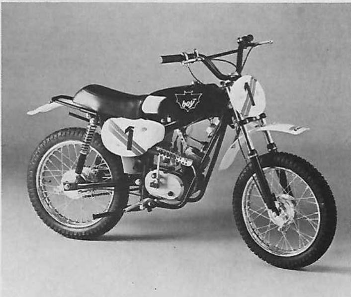
Moteur : 2 temps, monocylindre, cylindrée 47 cc, puissance 1 ch, allumage volant magnétique, lubrification par mélange à 5 %, mise en route par kick.
