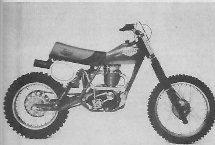
Moteur : 84 x 90 (498 cc) ou 90 x 90 (580 cc) ou même 90 x 95 (625 cc) ! Compression 110/1, 51 CV à 7 500 tr/mn. Carbu de 36 mm, transmission primaire par chaîne, freins : Ø 140 mm, amortisseurs Ohlin, fourche Marzocchi, débattement identique AV et AR, 310 mm. Empattement 1 520 mm. Contenance réservoir : 5 litres. Contenance huile : 2,5 l.
