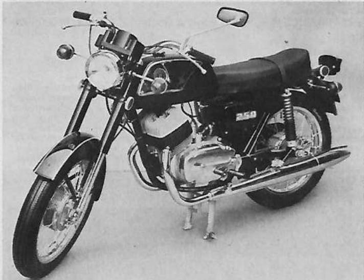
**Moteur :** 2 temps, bicylindre, alésage et course 52 mm x 58 mm, cylindrée 246,35 cm<sup>3</sup>, compression 9,3 à 1, puissance 16,5 ch à 5 250 tr/mn, couple maximum 2,3 m/kg à 4 800 tr/mn, 2 carburateurs Jikov Ø 24 mm, allumage C.Z., lubrification par mélange à 3 %, mise en route par kick.
