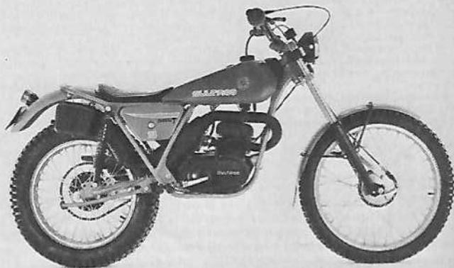
**Moteur :** 2 temps, monocylindre, alésage et course 43 mm x 51,5 mm, (74), 54,2 mm x 51,5 mm (125), cylindrée 74,788 cm<sup>3</sup> et 118,8 cm<sup>3</sup>, compression 11 à 1, puissances 6,63 ch et 9,12 ch à 7 000 tr/mn et 8 500 tr/mn, carburateurs Zenith 18 MX et Amal 2625, allumage alternateur à volant magnétique, lubrification mélange, mise en route par kick.
