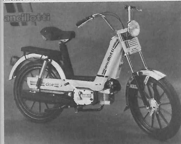
**Moteur :** Franco Morini à clapets 2 temps monocylindre, alésage et course 38,8 x 42 mm, cylindrée 49 cm<sup>3</sup>, compression 8 à 1, puissance 1,06 ch à 5 000 tr/mn, allumage volant magnétique, lubrification mélange, mise en route pédales.
