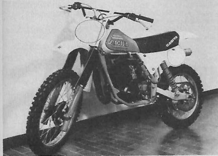
**Moteur :** 2 temps, monocylindre, alésage et course 72 mm x 58,2 mm, cylindrée 239,4 cm<sup>3</sup>, compression 14,1 à 1, carburateur Dell'Orto HS Ø 36 mm, allumage électronique Moto-plate, lubrification par mélange, mise en route par kick primaire.
