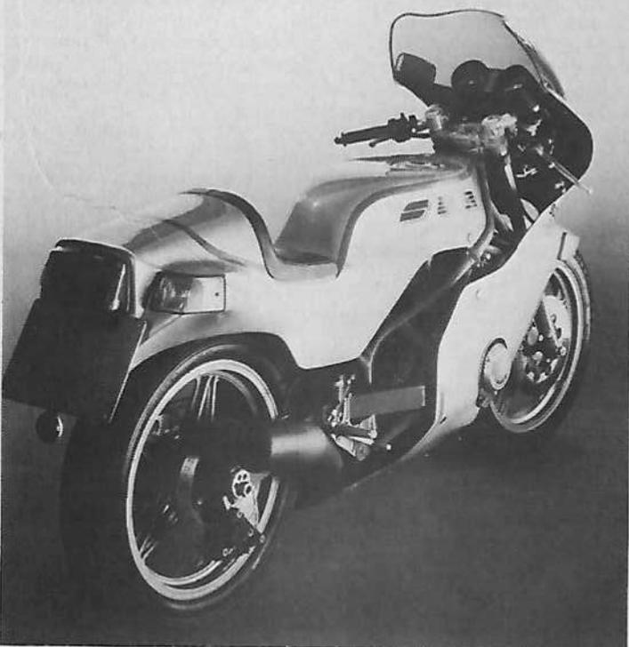
**Moteur :** 4 temps, 4 cylindres, alésage et course 70 mm x 64,8 mm, cylindrée 997 cm<sup>3</sup>, compression 9,2 à 1, puissance 90 ch à 9 000 tr/mn, couple maximum 7,84 m/kg à 7 500 tr/mn, 4 carburateurs Mikuni VM Ø 26 mm, allumage batterie - bobine, lubrification par carter humide, mise en route par kick + démarreur électrique.
