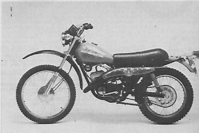
**Moteur :** 2 temps, monocylindre, alésage et course 56 mm x 50 mm, cylindrée 123,1 cm<sup>3</sup>, compression 10,8 à 1, puissance 17 ch à 7 250 tr/mn, couple maximum 1,2 m/kg à 7 250 tr/mn, carburateur Dell'Orto Ø 27 mm, allumage volant magnétique, lubrification par pompe à huile, mise en route par kick primaire.
