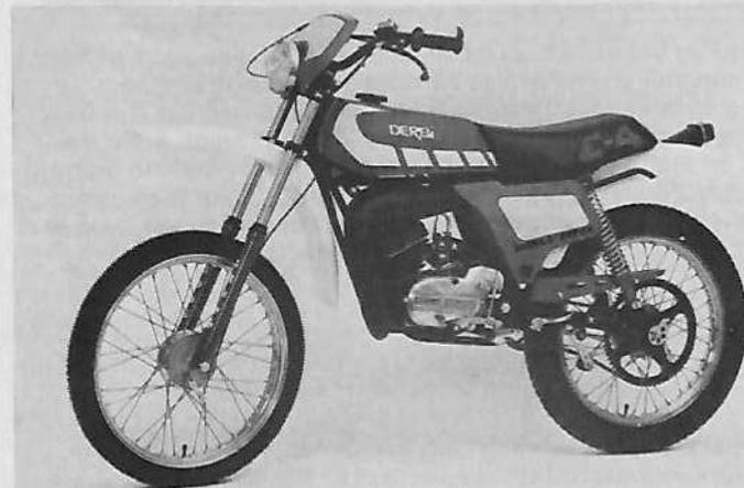
**Moteur :** 2 temps, monocylindre, alésage et course 38 mm x 43 mm, cylindrée 48,767 cm<sup>3</sup>, compression 9,5 à 1, puissance 2 ch à 5 200 tr/min, carburateur Dell'Orto Ø 12 mm, allumage volant magnétique Motoplat 6 V, lubrification par mélange, mise en route par kick.
