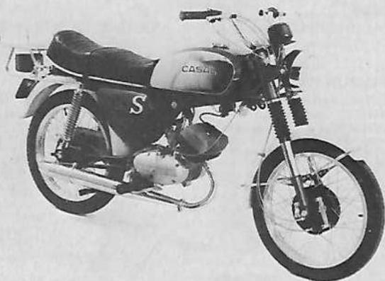
**Moteur :** 2 temps, monocylindre, alésage et course 40 mm x 39,7 mm, cylindrée 49,9 cm<sup>3</sup>, compression 8,5 à 1, puissance 6,5 ch à 8 500 tr/mn, couple maximum 0,6 m/kg à 8 000 tr/mn, carburateur Bing Ø 19 mm, allumage Bosch 8 6 V 25/4/5 W, lubrification par mélange, mise en route par kick.
