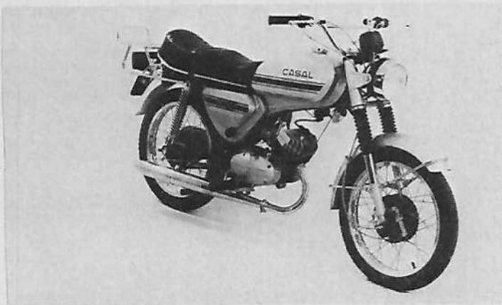
**Moteur :** 2 temps, monocylindre, alésage et course 40 mm x 39,7 mm, cylindrée 49,9 cm<sup>3</sup>, compression 8,5 à 1, puissance 5,3 ch à 7 500 tr/mn, couple maximum 0,5 m/kg à 7 500 tr/mn, carburateur Bing Ø 17 mm, allumage Bosch 6 V/17 W, lubrification par mélange, mise en route par kick.
