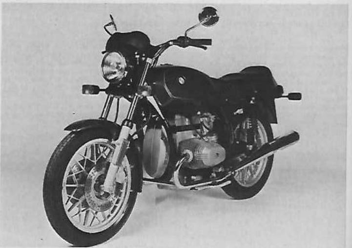
**Moteur :** 4 temps, 2 cylindres, alésage et course 70 mm x 61,5 mm, cylindrée 473,4 cm<sup>3</sup>, compression 9,2 à 1, puissance 35 ch à 7 250 tr/mn, couple maximum 3,8 m/kg à 5 500 tr/mn, 2 carburateurs Bing Equipression Ø 28 mm, allumage batterie - bobine, lubrification sous pression, mise en route par démarreur électrique.
