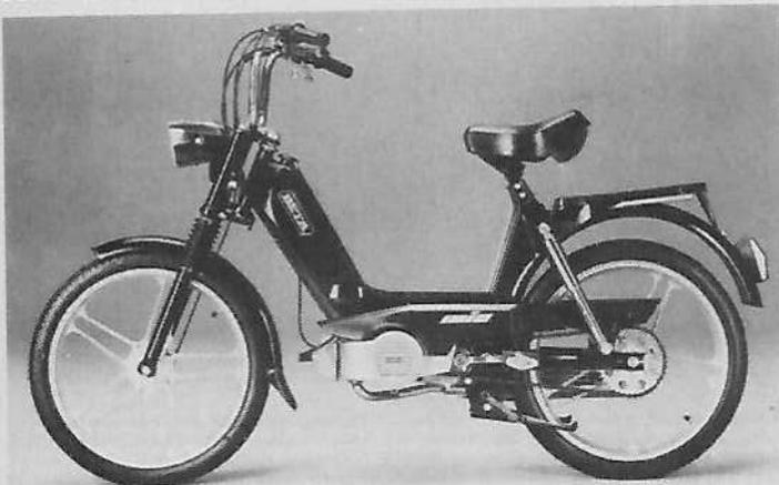
**Moteur :** 2 temps, alésage et course 40 mm x 39 mm, cylindrée 49 cc, alimentation par mélange à 3 %, carburateur Dell'Orto, allumage par volant magnétique.
