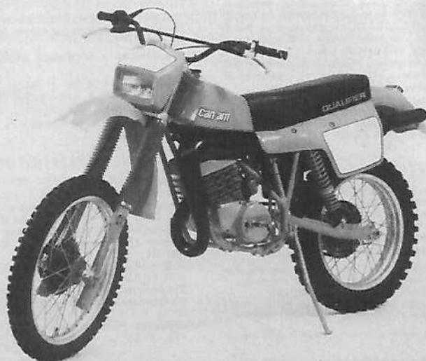
**Moteur :** 2 temps monocylindre, alésage et course 84 x 72 mm, cylindrée 399 cm<sup>3</sup>, compression 10,75 à 1, puissance 40 HP ch à 6 000 tr/mn, carburateurs Mik Ø 38 mm, allumage Bosch 6 pôles, lubrification par mélange, mise en route par kick.
