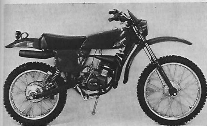
**Moteur :** 2 temps, monocylindre, alésage et course 42 mm x 38,8 mm, cylindrée 49,6 cm<sup>3</sup>, compression 11,3 à 1, puissance 2,4 ch, carburateur SHA Ø 14-12 mm, allumage volant magnétique, lubrification par mélange à 5 %, mise en route par kick.
