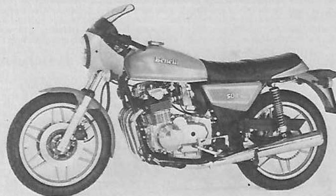
**Moteur** : 4 temps, 4 cylindres, alésage et course 56 mm × 50,6 mm, cylindrée 498 cm<sup>3</sup>, compression 10,2 à 1, puissance 52 ch à 8 900 tr/mn, 4 carburateur Dell'Orto Ø 22 mm, allumage batterie-bobine lubrification par carter humide, mise en route par kick + démarreur électrique.
