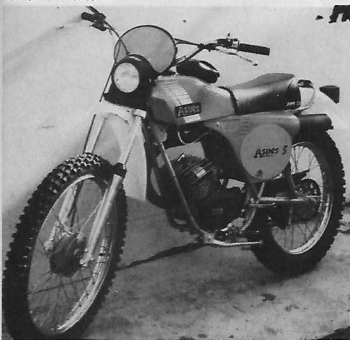
**Moteur :** 2 temps, monocylindre, alésage et course 54 mm x 54 mm, cylindrée 124 cm<sup>3</sup>, compression 10 à 1, puissance 21 ch à 9 500 tr/mn, carburateur Dell'Orto Ø 30 mm, allumage électronique Motoplatt ou Dansi, lubrification par mélange à 5 %, mise en route par kick.
