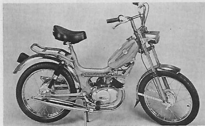
**Moteur :** 2 temps, monocylindre, alésage et course 42 mm x 38 mm, cylindrée 47,6 cm<sup>3</sup>, compression 7,7 à 1, puissance 2 ch, carburateur SHA Ø 14-12 mm, allumage volant magnétique, lubrification par mélange à 5 %, mise en route par kick.
