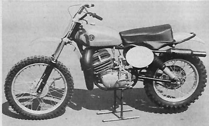
**Moteur :** 2 temps, monocylindre, alésage et course 82 mm x 72 mm, cylindrée 380 cm<sup>3</sup>, compression 11 à 1, puissance 42 ch à 6 600 tr/mn, couple maximum 4,40 m/kg à 6 000 tr/mn, carburateur Jikov Ø 36 mm, allumage C.Z. 6 V, lubrification par mélange à 5 %, mise en route par kick.
