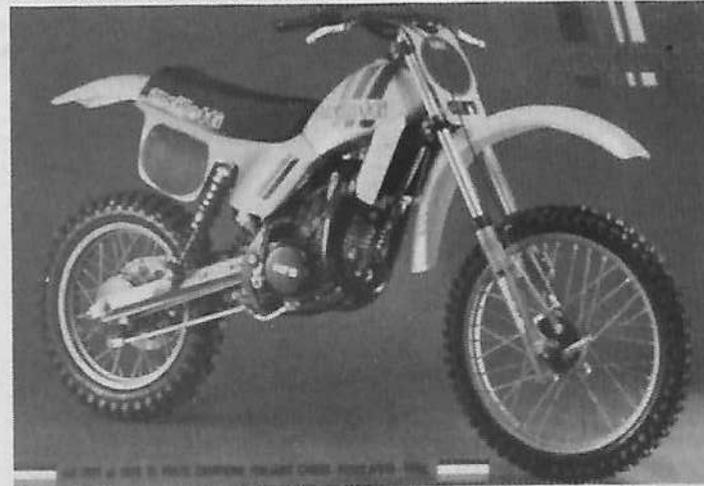
**Moteur :** Type monocylindre 2T refroidi par eau, alésage et course 54 x 54 mm, cylindrée 123,6 cm<sup>3</sup>, taux de compression 13 : 1, puissance maxi 29 ch à 10 500 tr/mn, allumage Kukugan électronique à avance variable, bougie Marelli CWP 10 L (310 d'indice thermique) lubrification mélange 5 %, alimentation carbu Mikuni Ø 34 mm + clapets brevet Hiro, démarrage kick starter, vitesse enclenchée.
