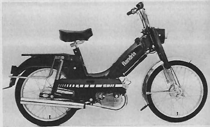
**Moteur :** 2 temps, monocylindre, alésage et course 40 mm x 39,7 mm, cylindrée 49,7 cm<sup>3</sup>, compression 7 à 1, puissance 2 ch à 5 000 tr/mn, couple maximum 0,32 m/kg à 4 000 tr/mn, carburateur S 33 Ø 12 mm, allumage volant magnétique 6 V, lubrification par mélange à 5 %, mise en route par rétrokick.
