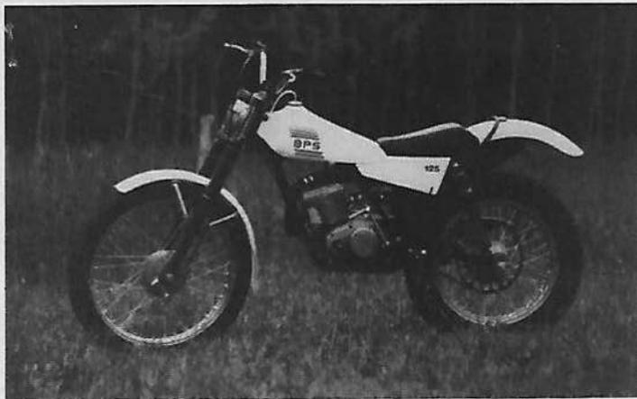
**Moteur :** Franco Morini, 2 temps, monocylindre, alésage et course 54 mm x 54 mm, cylindrée 123,6 cm<sup>3</sup>, compression 10,5 à 1, puissance 13 ch à 6 800 tr/mn, carburateur Dell'Orto Ø 22 mm, allumage volant magnétique, lubrification par mélange, mise en route par kick.
