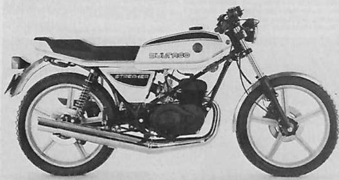
**Moteur :** 2 temps, monocylindre, alésage et course 43 mm x 51,5 mm (54,2 mm x 51,5 mm) cylindrée 74,7 cm<sup>3</sup> (118,8 cm<sup>3</sup>), compression 11,5 à 1 (12 à 1), puissance 8,84 ch à 8 300 tr/mn (14 ch à 9 000 tr/mn), carburateur Bing 84 Ø 26 mm, allumage électronique Motoplat, lubrification par mélange, mise en route par kick.
