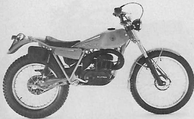
**Moteur :** 2 temps, monocylindre, alésage et course 83,2 mm x 60 mm, cylindrée 326,2 cm<sup>3</sup>, compression 9 à 1, puissance 20,8 ch à 6 500 tr/mn, couple maximum 2,76 m/kg à 4 000 tr/mn, carburateur Bing Ø 28 mm, allumage magnéto - alternateur à volant avec rupteur, lubrification par mélange, mise en route par kick.
