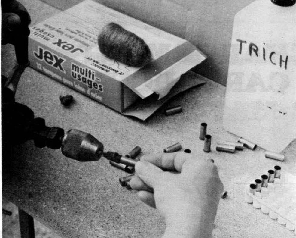
Le tampon « Jex » enroulé sur un vieil écouvillon passe dans l'étui dans un mouvement rotatif donné par la perceuse. Le frottement doit être suffisant pour enlever les déchets de poudre brûlée et les traces de plomb.
