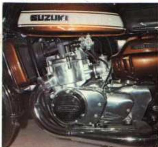
Moteur : 3 cylindres 2 temps refroidi par eau
