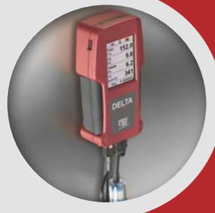
**Utilisation mains libres**, analyseur équipé de 4 fixations magnétiques sur la face arrière
