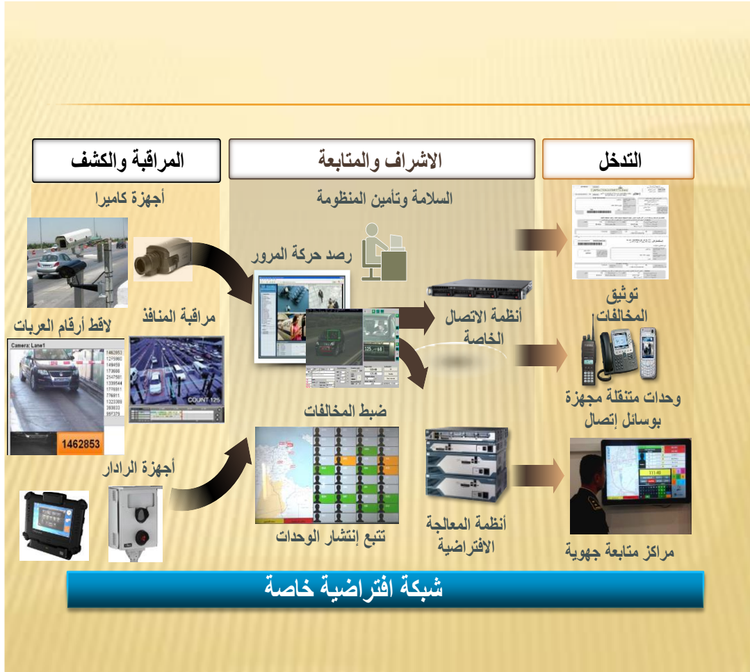
الشكل رقم 05: أجزاء منظومة المراقبة الآلية
