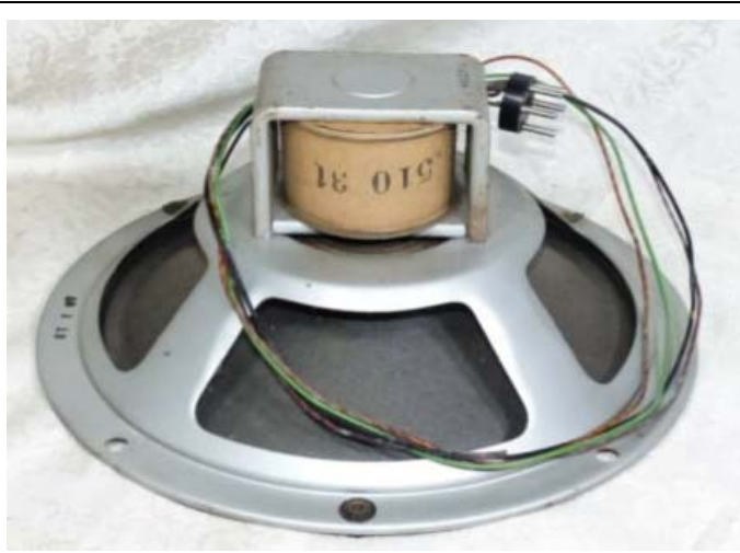
Dans les premiers haut-parleurs à membrane, le champ magnétique fixe de l'aimant de courant était appliqué par une seconde grande bobine d'induction alimentée directement par la tension continue de l'alimentation.
