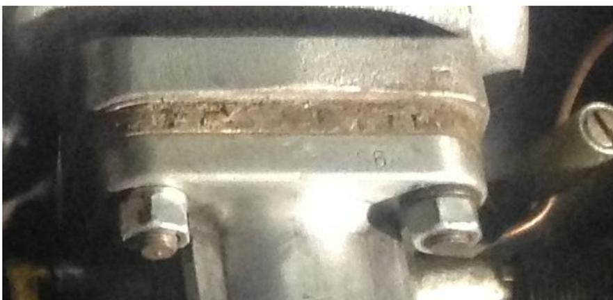
Alors comment differencier les H6 des HS Le S veut dire short en effet a force de rallonger l'inlet manifold au file des modèles pour gagner de la puissance, l'ensemble ne rentre plus dans le compartiment moteur/capot aussi les dernier inlet manifold seront courbés et l'embase du SU raccourci d'où S.
