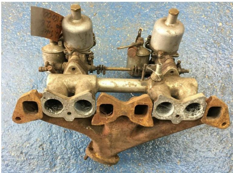
Type 2 : 302118 lowport pour TR3 jusqu'au numero **moteur TS9349E** avec carburateurs H6
