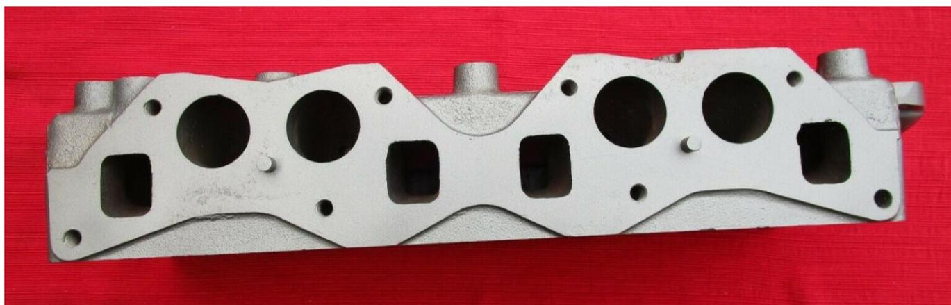
Ces culasses ont été montées sur des TR2 et TR3 pour en accroître la puissance à 105 cv (mais il ne s'agissait pas de montage d'origine)
