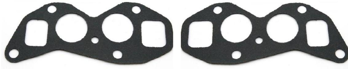
Non démonté, un autre facteur différenciant est la position relative du collecteur d'admission par rapport au collecteur d'échappement, sur un lowport les collecteurs sont pratiquement au même niveau :
