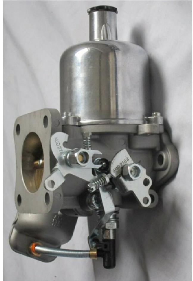
Il a existé deux variantes les AUD209 en configuration standard et les AUD284 en configuration américaine (norme pollution : jet et aiguille différentes)
