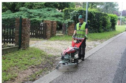
La nouvelle acquisition de la commune, cette drôle de machine permet de nettoyer et désherber les caniveaux, sans pesticides.
