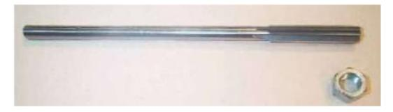
Un alésoir de cinq dollars et un écrou de 20 cents sont les principales pièces nécessaires. Deux vis de réglage 8-32 maintiendront l'écrou en place.
