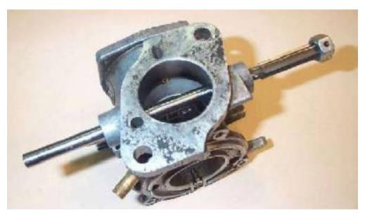
Le corps du carburateur est maintenu dans l'étau avec des bandes de laiton le protégeant. L'alésoir est mieux entraîné à la main, retirer le fréquemment pour enlever les copeaux avec un léger jet d'air. Nous avons utilisé WD-40 pour la lubrification.
