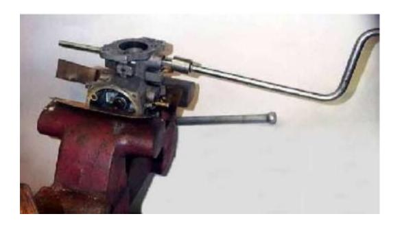
L'alésoir est tenu par les anciennes bagues pour la premiere passe, et par l'ancienne et une bague de remplacement pour la deuxième passe. Ce processus a toujours fonctionné pour nous et pour plusieurs autres propriétaires de MG pour lesquels nous avons expliqué la procédure
