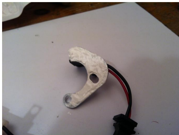
Module enduit de pâte prêt pour le montage sur la platine
