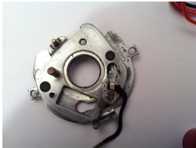
Platine supérieure prête pour recevoir le module
