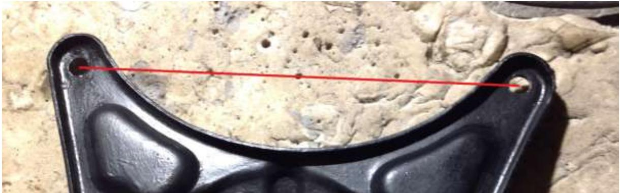
Enfin, bien vérifier avant le montage final que l'écrasement des silentblocs du bas de l'amortisseur permet bien de monter les deux pattes dans les quatre vis de la plaque du triangle inférieur
