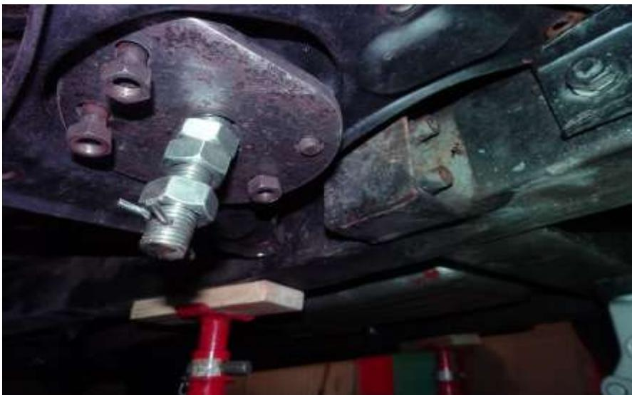
J'ai enlevé les deux boulons au milieu des deux wishbones et remplacé les deux boulons par deux boulons plus longs en effet le ressort exerce encore des efforts en bout des boulons d'origine
