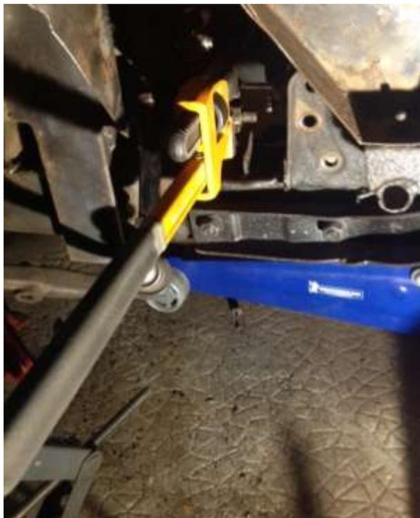
La clef à griffe permet de mettre la bague en rotation, mais l'extraction de l'axe reste difficile.
