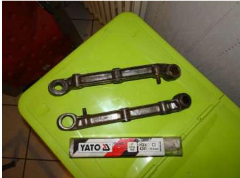
Après avoir remis à blanc les wishbones, je passe une première couche de transformateur de rouille Loctite 7503, et un primaire marin anti-corrosion Neptofe ( je lui trouve un excellent pouvoir couvrant, tout en assurant un bon grippe pour le couche suivante) , y compris dans l'alésage coté châssis. Pour la finition deux couches de peinture epoxy chassis (pas dans les alésages)
