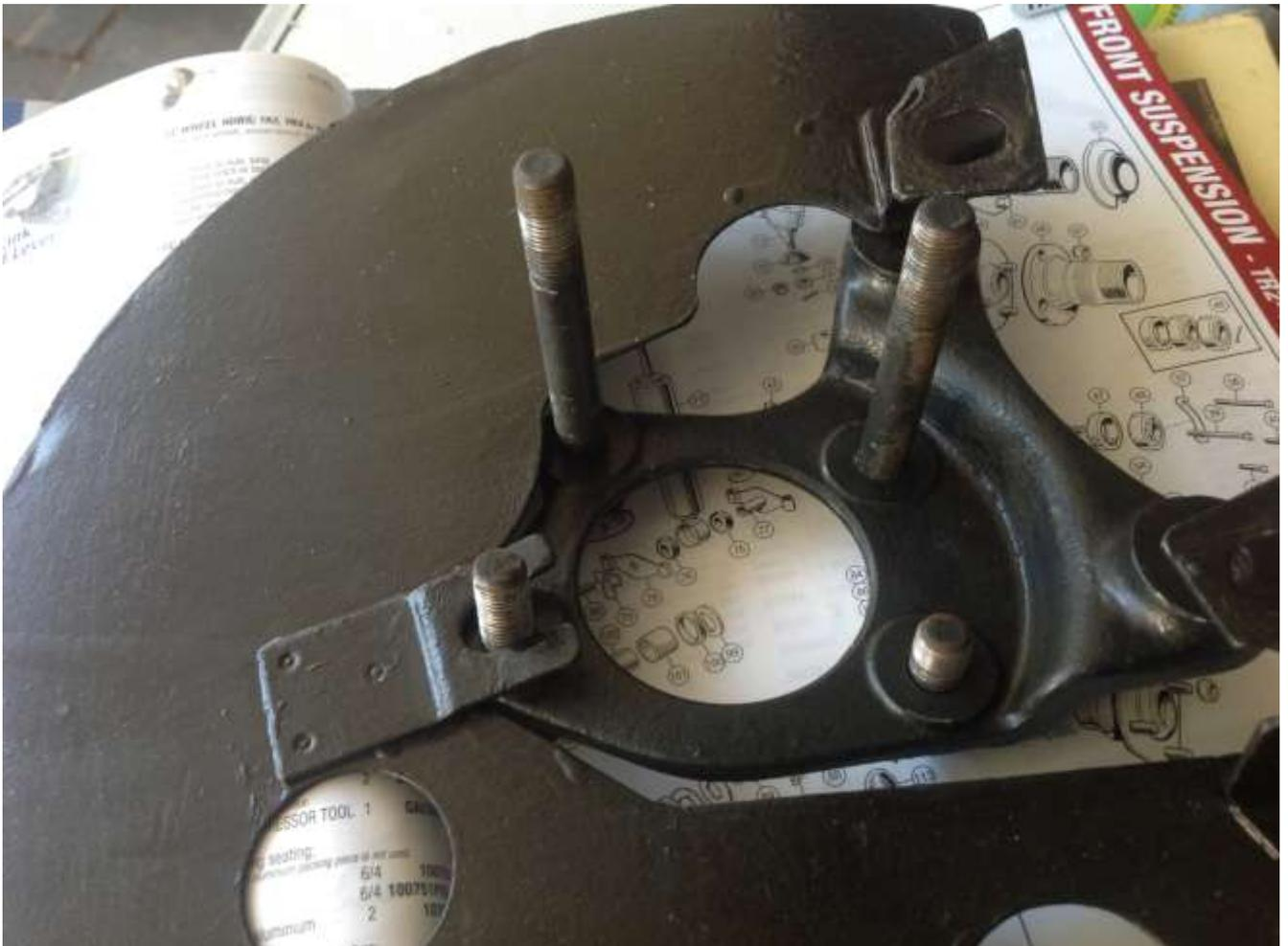
Monter le joint avec le feutre bien huilé coté moteur plus le roulement
