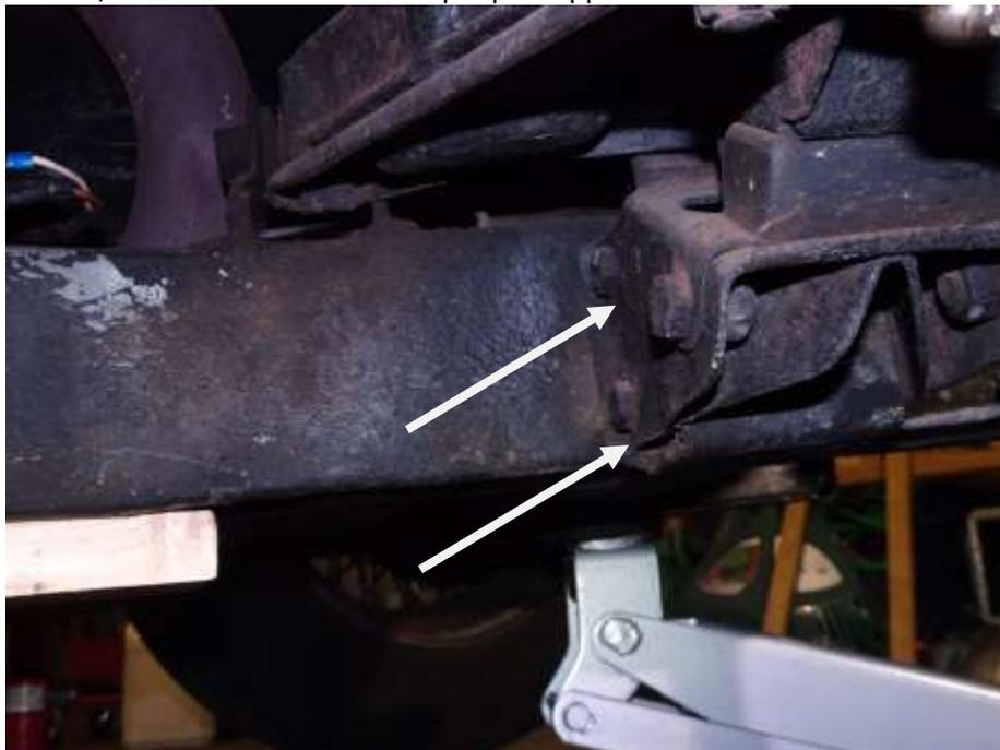
Il faut enlever les deux boulons le long du châssis, si tout se passe bien, ils sortent ; sinon c'est la galère en effet les deux tubes peuvent en raison de l'oxydation restent solidaires des vis et les plaques qui les supportent en position en général bien corrodées par l'intérieur ne résistent pas à l'effort de torsion :
