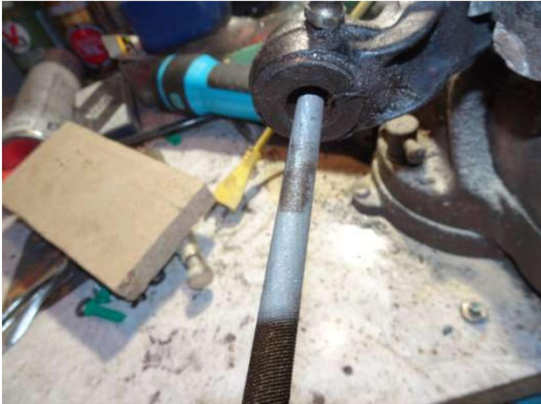
Bien observer l'alésage de le coté et regarder périodiquement le métal que vous enlevez. il faut être bien parallèle à la bague ; parfois lorsqu'on arrive à la limite entre la bague et le wishbone on voit un changement de couleur. Ne pas hésiter à s'arrêter trop tôt plutôt que trop tard et passer à la phase suivante :
