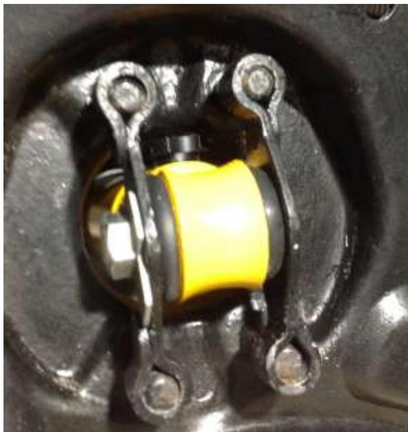
Fixer le vertical link en le vissant dans le trunnion après avoir insérer le joint .
