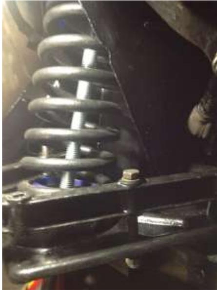
Comprimer le ressort jusqu'à ce que la plaque soit en appui sur les wishbones et dans les deux goujons . Mettre les 6 écrous et bien serrer.
