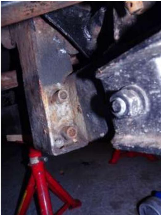
Bien traiter le corps creux derrière ces deux tubes : aspirer le sable/terre/pierre qui ont trouvés refuges dans ce tube rectangulaire depuis 60 ans, enlever le maximum de rouille avec une fraise montée au bout d'un flexible, aspirer de nouveau, traiter avec produit transformation de rouille type Loctite 7503 et peindre à l'époxy ce corps creux
