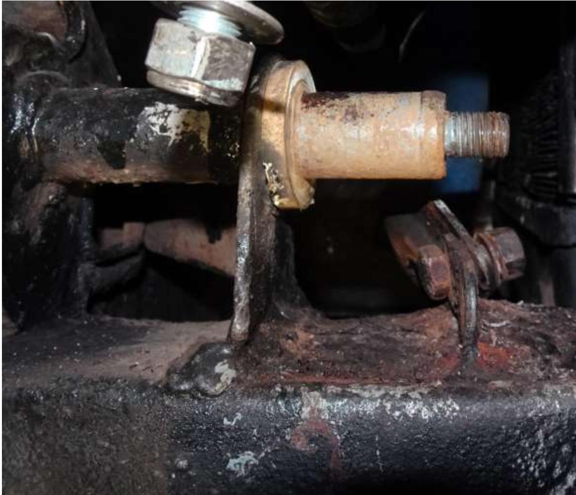
La solution qui marche est de lubrifier avec un vrai dégrissant pendant deux à trois jours puis d'affaiblir la bague longitudinalement ;
