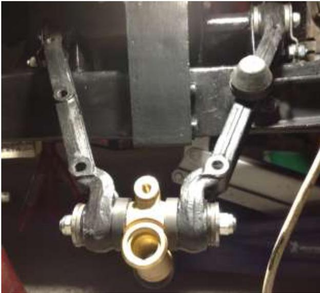
Trois causes sont possibles en cas de mauvaise rotation : soit le serrage des deux écrous est trop important, soit l'alésage des deux bagues est limite, soit votre axe sur le châssis est tordu.
