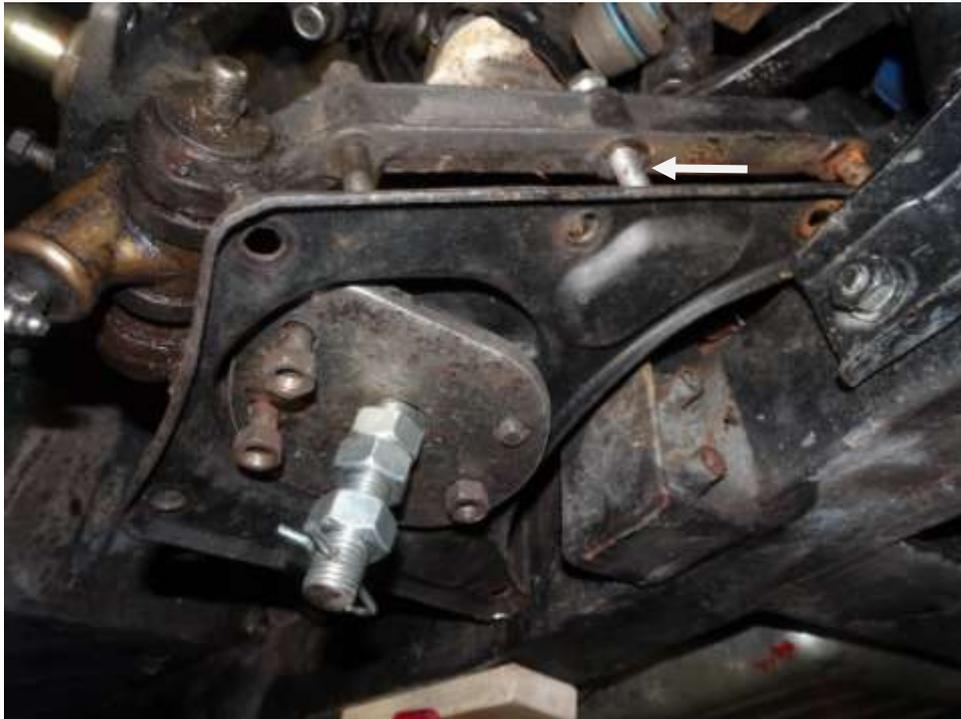
Le plus difficile est de sortir les deux écrous coté châssis, ne pas hésiter à utiliser un cric pour éviter que la plaque se mette en travers par rapport au goujon (en gardant toujours la tige fileté en sécurité)
