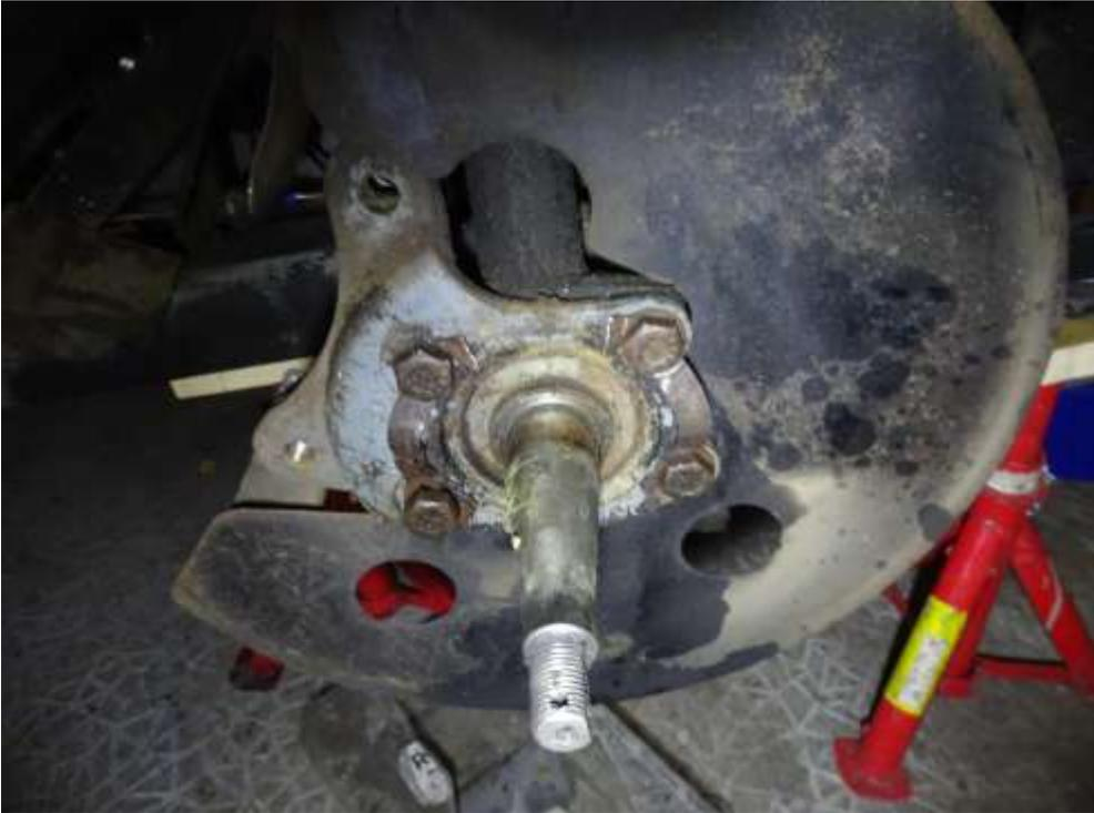
En enlevant les 4 boulons on peut enlever le flasque et la plaque de protection du disque
