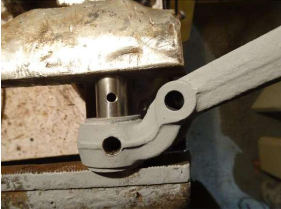
La cote intérieure de la bague une fois insérée dans le wishbone est 15,20 mm.
