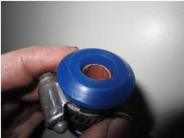
Lubrifier avec du liquide vaisselle le bout de la bague et le début de l'alésage.
