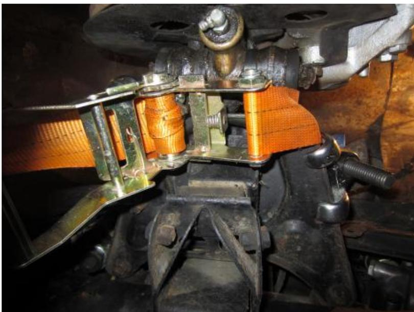
Remarque : l'utilisation de la sangle à cliquet n'est utilisée que pour mettre en contact le cône de la rotule. Son usage est absolument interdit pour la compression des ressorts.
