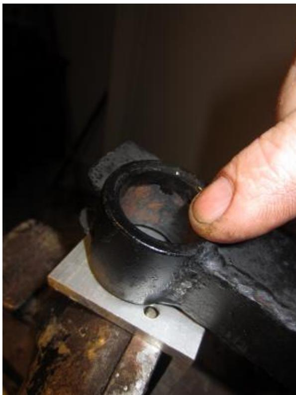
Bien faire rentrer le premier bourelet avec un tournevis non coupant. C'est relativement facile puisque que le tube cuivre ne vient pas jusque là. Si vous oubliez un seul centimètre, la bague va se mettre en travers.
