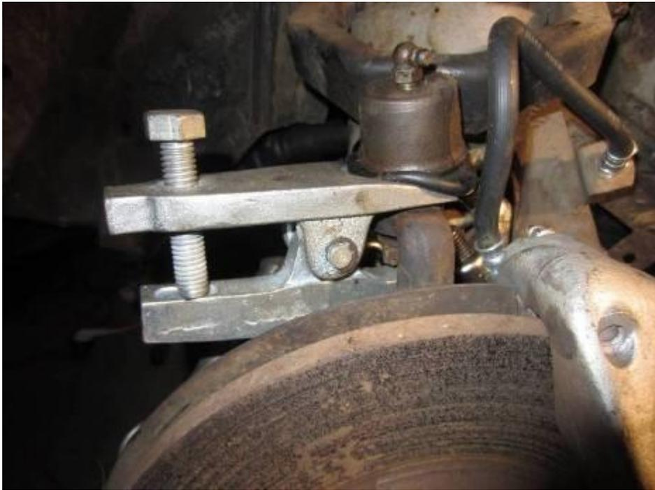
Lorsque les partie conique du l'axe de la rotule et la partie supérieure du « vertical link » sont désaccouplés, l'axe est libre et si vos ressorts sont bien bridés, le wishbone bouge librement. Si les ressorts non pas été suffisamment bridés, l'axe vient en butée sur l'écrou que vous avez laissé sur l'axe (si vous n'aviez pas mis les griffes et enlevé le boulon avant de faire fonctionner l'arrache moyeu : direction l'hôpital)
