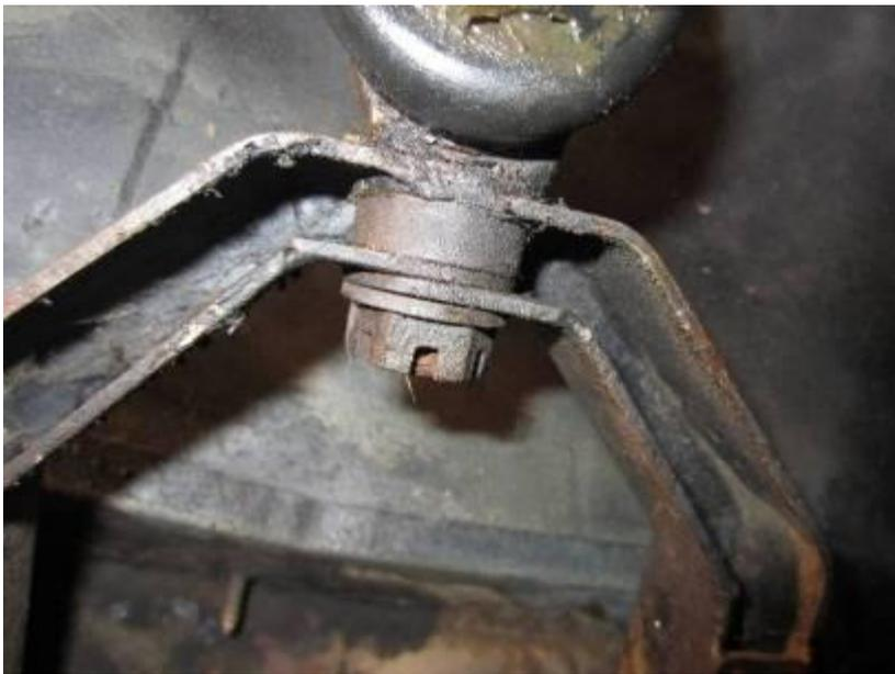
Ensuite démonter les deux goupilles sur les écrous qui relient le wishbone au fulcrum pin.
