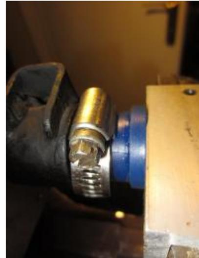
Bien mettre des appuis bien perpendiculaires, pour terminer mettre une douille qui vient en appui sur le wishbone pour permettre à la bague de bien traverser.
