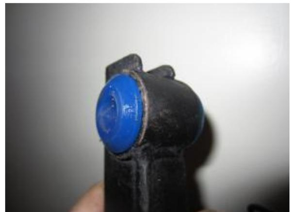
Le remontage des deux wishbones ne pose pas de problèmes particuliers (lubrifier les deux bagues avec la graisse vendu avec, ne pas trop serrer)
