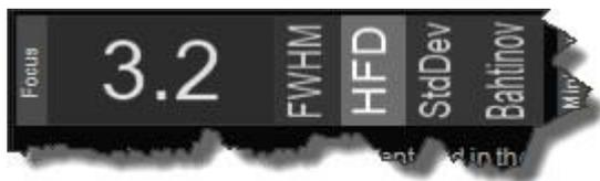
Votre objectif, lors de l'utilisation de HFD, est d'ajuster la mise au point jusqu'à ce que la valeur HFD soit aussi faible que possible pour une seule étoile au fil du temps.
