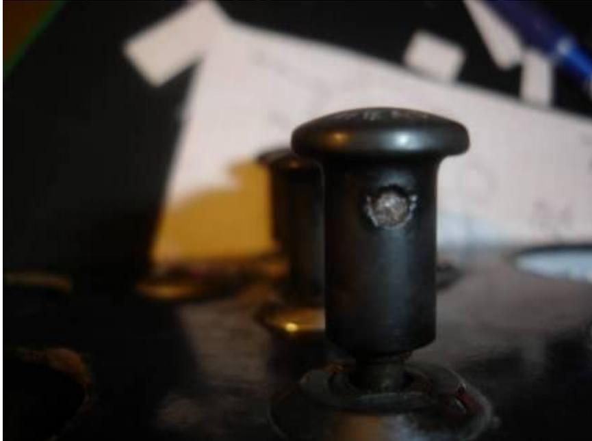
Pour enlever le bouton, utiliser une petite perceuse type Dremel et avec une fraise, détruire le piston ce qui permet de sortir le bouton sans le casser.
