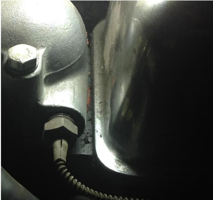
**Si votre sonde reste solidaire de l'écrou de blocage : toute rotation de 360° la sonde, laisser tourner (ou faire) le tube et la jauge sur le porte instruments de 360° (pour ne pas vriller le tube caloporteur)**
