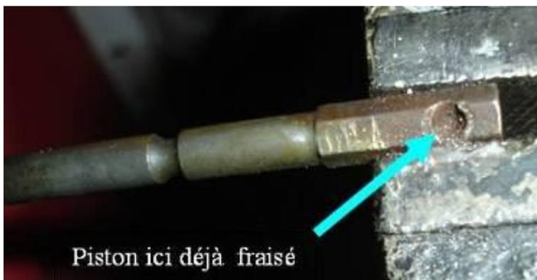
Percer avec un foret de 2,5mm (attention à être bien perpendiculaire à l'axe), puis tarauder à 3 mm (ce n'est pas dans les règles de l'art mais c'est du laiton...)
