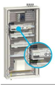
Coffret Prisma avec jeu de barres Powerclip et arrivée de la terre par le bas. Le conducteur de terre du parafoudre est relié au plus près à la structure du coffret (pour cela, utiliser les vis striées Prisma pour assurer un contact parfait)
