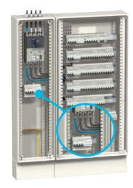
Armoire Prisma avec jeu de barres Powerclip et gaine. Le conducteur de terre arrive par le bas. Le conducteur de terre du parafoudre est relié au plus près à la structure du coffret (pour cela, utiliser les vis striées Prisma pour assurer un contact parfait). Le parafoudre est installé dans la gaine au plus près de la protection de tête.
