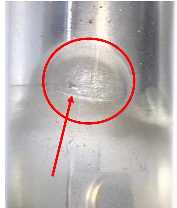
Trou dans la céramique et attaque de «Métal» sur l'ampoule
