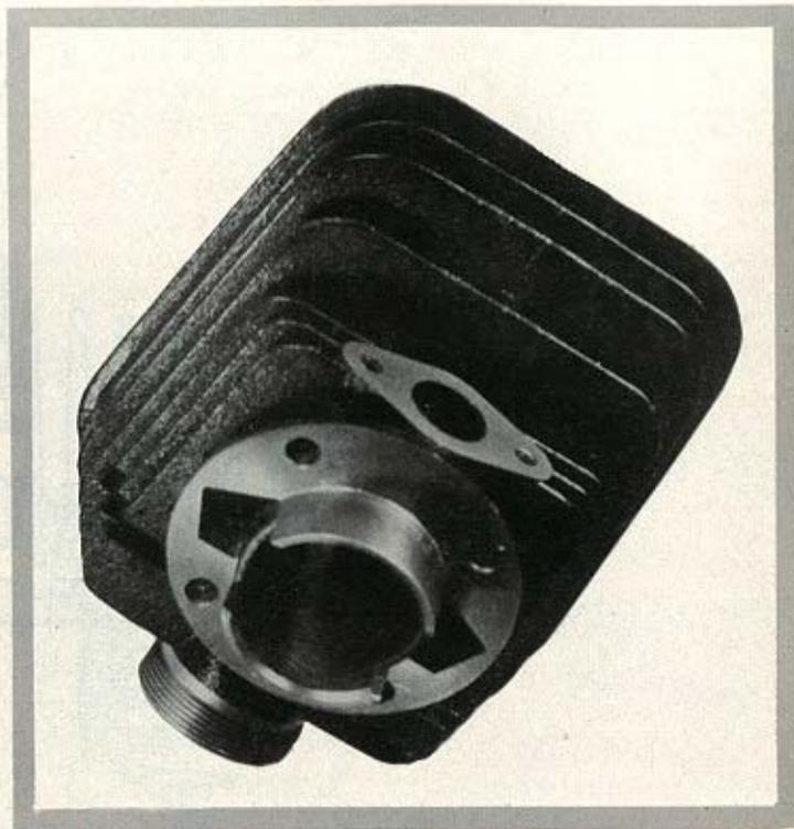
Les ailettes du cylindre sont interrompues de chaque côté de l'échappement. Remarquer par ailleurs la longueur des ailettes supérieures arrière.
