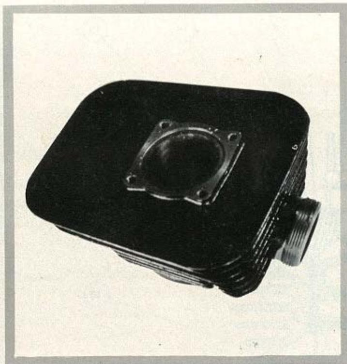
Le plan de joint supérieur du cylindre en fonte est du type à brisement.
