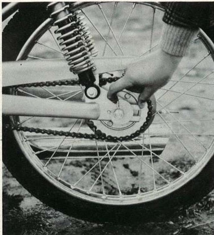
La tension de la chaîne s'opère par deux escargots. Le pignon arrière dissimule un amortisseur de transmission par blocs de caoutchouc. La suspension arrière s'est révélée particulièrement agréable. Nous ne pouvons passer sous silence le carter de chaîne secondaire bien que le problème soit moins grave sur un 50 cm<sup>3</sup>.
