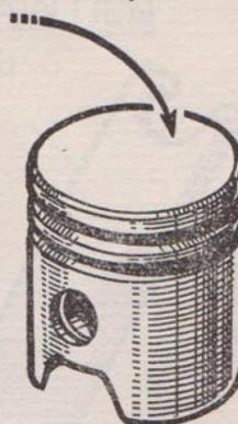
**TAILLE du CYLINDRE** : est indiquée par un chiffre (ou un nombre) gravés à l'endroit de la flèche, sur l'embase côté échappement.
