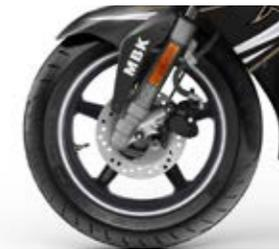
Jantes 13 pouces, pneus taille basse, freins avant et arrière à disque de 190 mm.
