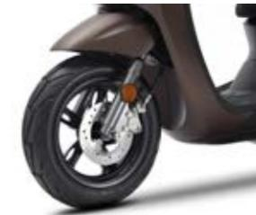
Fourche hydraulique et frein à disque de 190 mm à l'avant pour plus de confort et de sécurité.
