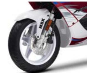
Jantes 13 pouces, pneus taille basse, freins avant et arrière à disque de 190 mm.
