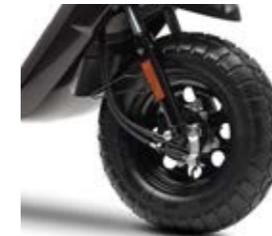
Freins avant et arrière à tambour de Ø 110 mm. Pneus extra large, unique pour un 50 cm<sup>3</sup>.
