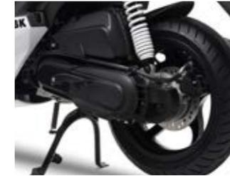
Moteur 4 temps 50 cm<sup>3</sup> à refroidissement liquide économique en carburant et facile d'entretien.
