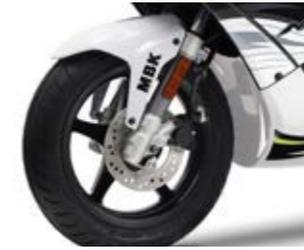
Jantes 13 pouces, pneus taille basse, freins avant et arrière à disque de 190 mm.
