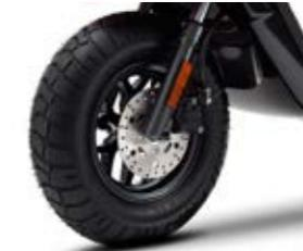
Des roues de 10 pouces et un frein à disque de 180 mm à l'avant garantissent une excellente accroche et un freinage puissant.
