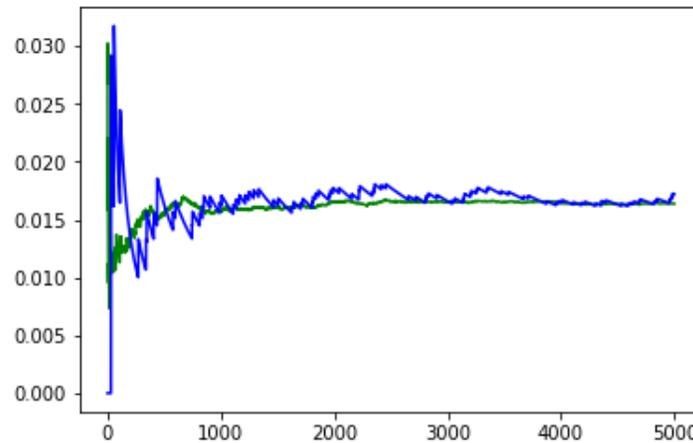
FIGURE 3 – L'estimation de delta par le calcul Malliavin en vert et par différences finies en bleu
