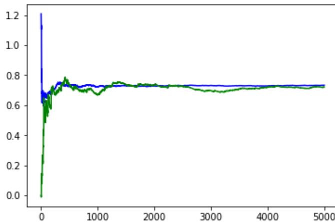
FIGURE 1 – L'estimation de delta par le calcul Malliavin en vert et par différences finis en bleu
