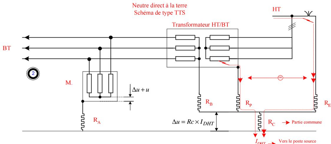
Lors d'un amorçage des éclateurs (il s'agit ici d'un réseau HT de type Aérien) ou en cas d'un amorçage à la masse dans l'installation HT, le courant de défaut HT s'écoule soit à travers la prise de terre des éclateurs (Ici parafoudre à cornes anti-oiseaux) soit à travers de la prise de terre des masses HT.
