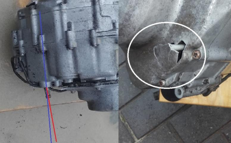
Encore une galère, ... Les vis sont oxydées dans le carter C'est de la "Corrosion électrolytique"
