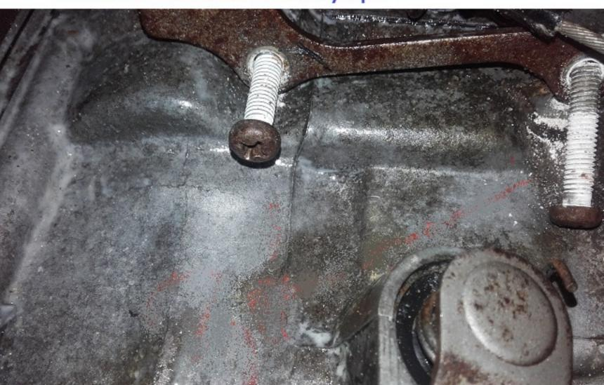
L'axe du sélecteur (Tordu) a pu être retiré +/- facilement
