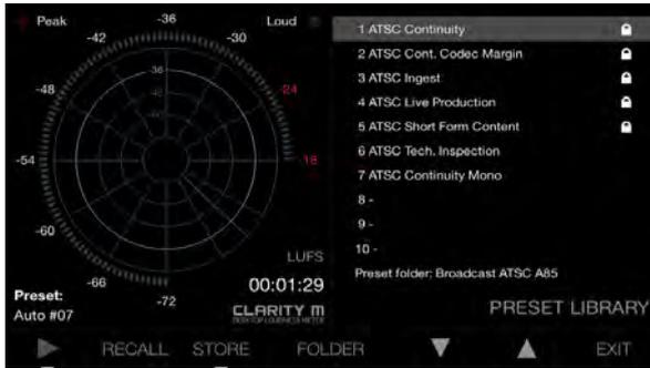
Les préréglages sont composés de paramètres figurant sur la page Modifier. Les paramètres RTA et Radar sont stockés dans un préréglage. Appuyez sur le 4ème bouton pour accéder au menu Bibliothèque. Faites défiler les dossiers disponibles avec le bouton rotatif pour sélectionner la catégorie la plus appropriée.
