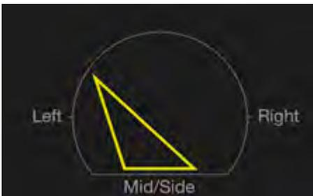
Le point haut sera incliné dans les deux sens au fur et à mesure que les canaux deviennent moins équilibrés, et la base apparaîtra plus étroite pour indiquer moins de largeur.
