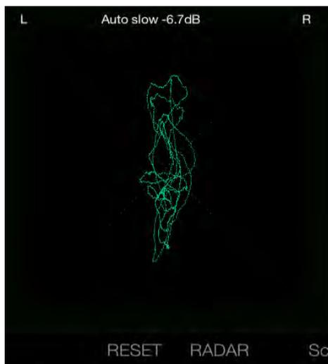
Les canaux stéréo identiques (mono) apparaîtront sous forme de ligne droite et toute séparation stéréo sera visible sous forme de déviation par rapport à cette ligne.
