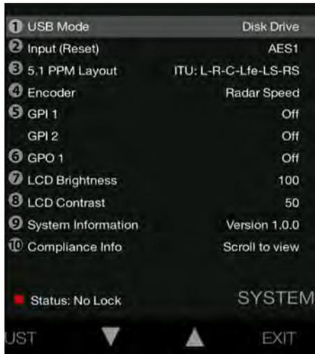
1. Lorsque le Clarity M est connecté à un ordinateur via USB, il peut fonctionner dans deux modes (modes USB):
