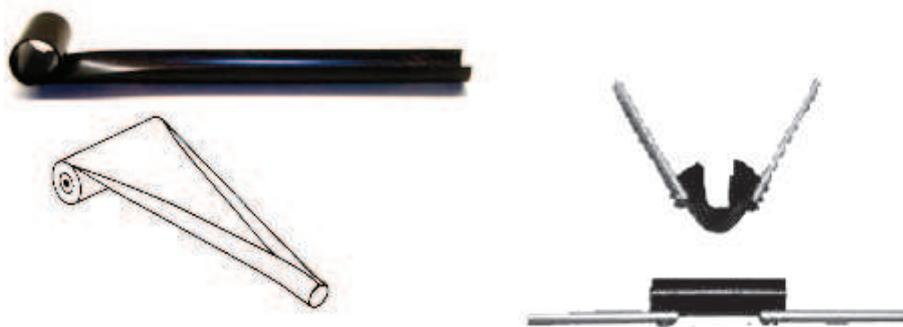
Figure 1-26 : ruban et articulation en matériau composite
