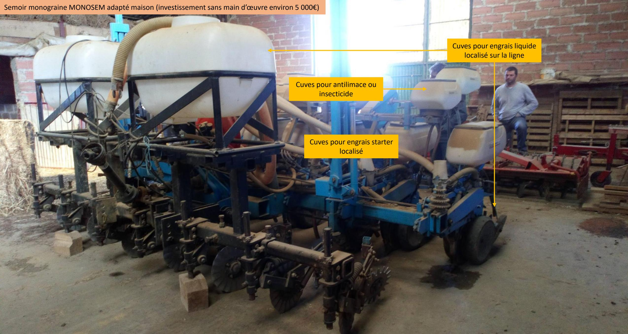
Cuves pour engrais liquide localisé sur la ligne
