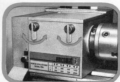
Changement des vitesses de la broche par leviers. Plus de courroies à changer.
