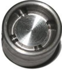
Un lissoir, acier ou laiton, à monter sur une perceuse (à colonne) ou la "manivelle" de nos (arrières) grands-pères.
