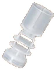
Bourre plastique qui permet une meilleure étanchéité de par sa base expansive. Les gaz ne passant pas autour de la bourre, les plombs sont moins déformés par la chaleur et la gerbe de plomb n'est pas perturbée. Les plombs étant enserrés dans un godet, il n'y a pas de phénomènes d'emplombage , se disperseront plus tard qu'avec une bourre grasse augmentant ainsi la portée utile. Etant plus étanche la pression augmente. On diminuera la dose de poudre.
