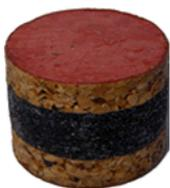
Il s'agit d'un cylindre placé entre la poudre et les plombs. L'avantage de ce type de bourre est une dispersion plus importante des plombs. La matière utilisée est généralement du feutre, du liège graissés ou non. Celles en fibres sont très dures, avec peu de déformation et ont tendance à produire des gerbes moins homogènes. Les plombs, n'étant pas protégés, frottent les parois du canon provoquant un phénomène d'emplombage et surtout leur déformation.
